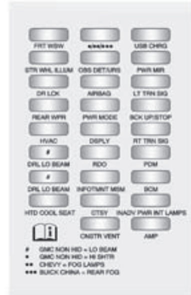
Lado de fusibles
