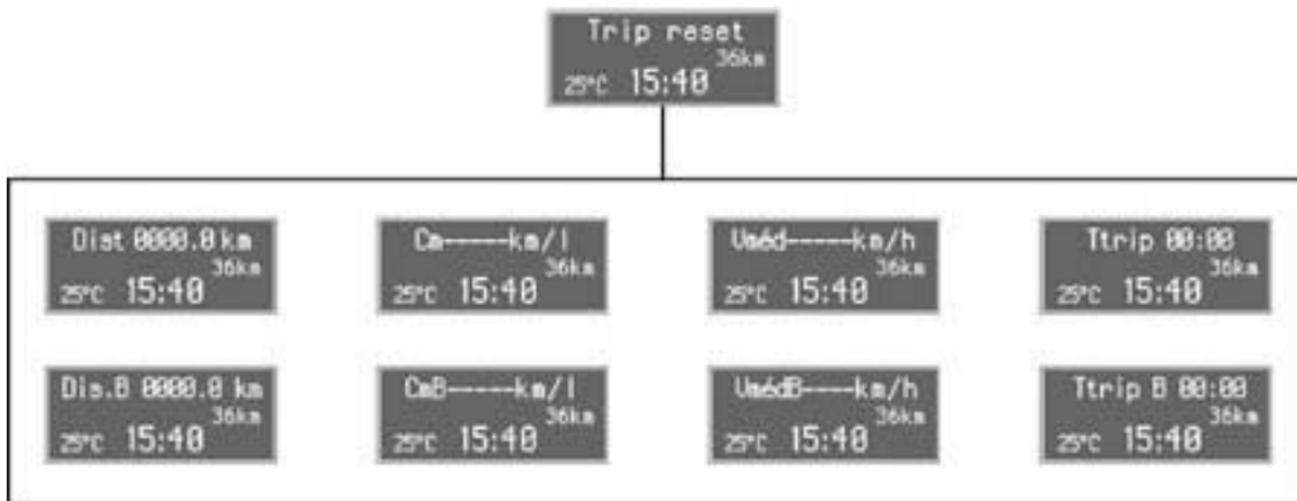
El TRIP B posee un reset (puesta a cero) independiente, que puede ser realizado cuando uno de sus datos esté siendo visualizado en el display, presionando el botón Trip durante un tiempo superior a 2 segundos.
