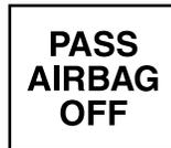
**Nota:** la luz indicadora permanece encendida durante un período breve cuando el encendido se coloca en la posición ON para confirmar que esté funcionando.
