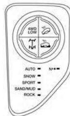
Interruptor 4x4 de 2 velocidades (con bloqueo trasero)
