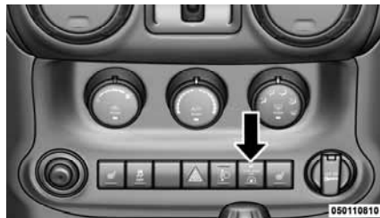
Conmutador STOP/START OFF
