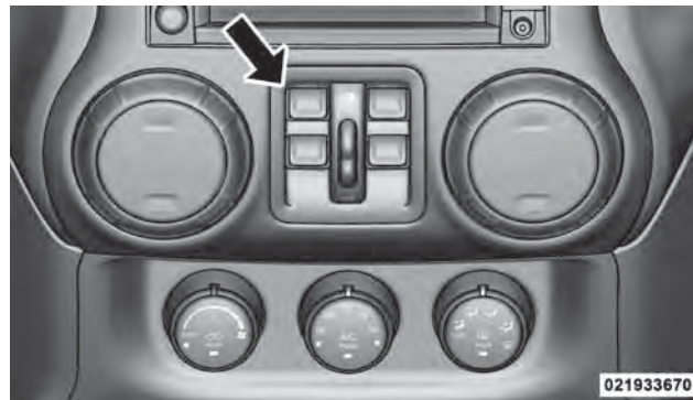
Elevadores eléctricos de cristales
