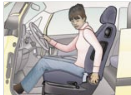
3. Reglaje de la inclinación del respaldo.
