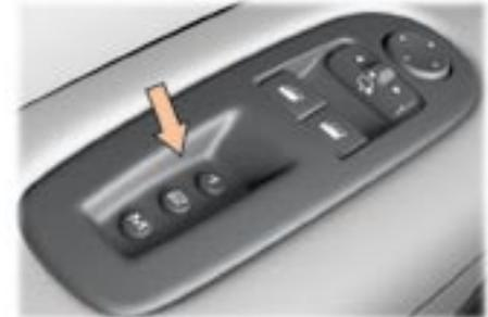
La memorización tiene en cuenta el reglaje eléctrico del asiento conductor, del volante y de los retrovisores exteriores. Tiene la posibilidad de memorizar dos posiciones de conducción con las **teclas M/1 y M/2**.
