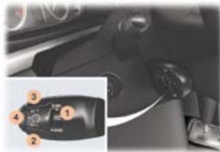
Permite no sobrepasar la velocidad del vehículo programada por el conductor (velocidad mínima de 30 km/h).
