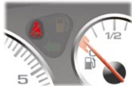
Al poner el contacto, si un pasajero delantero no se ha abrochado su cinturón de seguridad y si la velocidad es inferior a 20 km/h, usted es avisado por el testigo de cinturón que se enciende.
