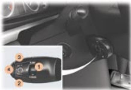
Permite mantener, de manera constante, la velocidad del vehículo programada por el conductor.
