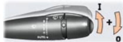
La intervención manual en el mando del limpiaparabrisas moviendo la palanca **A** hacia arriba y volviéndola a poner en posición **"0"** interrumpe la posición **AUTO**, el testigo de neutralización se enciende en la pantalla del combinado, acompañado de un mensaje en la pantalla multifunción.
