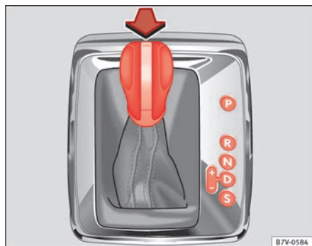
Fig. 132 Vehículos con volante a la derecha: Palanca selectora del cambio automático con tecla de bloqueo (flecha).
