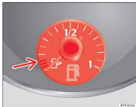
Fig. 162 En el cuadro de instrumentos: indicador del nivel de combustible para gasolina y diésel.
