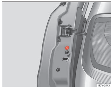
Fig. 189 En la parte frontal de la puerta del acompañante: Bloqueo de emergencia, oculto por una junta de goma.
