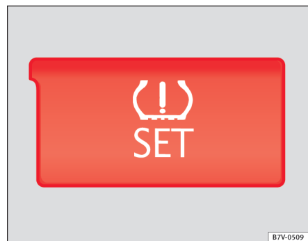
Fig. 154 Detalle de la consola central: tecla del indicador de la presión de los neumáticos.
