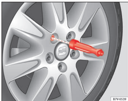
Fig. 185 Cambio de rueda: aflojar los tornillos de la rueda con el mango del destornillador.
