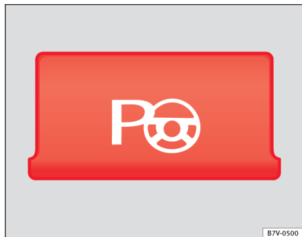
Fig. 144 Detalle de la consola central: tecla para conectar manualmente el sistema de asistencia al volante para aparcarse.
