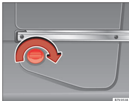
Fig. 164 En la parte trasera izquierda del maletero: depósito de AdBlue, detrás de una cubierta.
