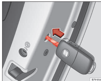
Fig. 190 Bloqueo de emergencia del vehículo con la llave del vehículo.
