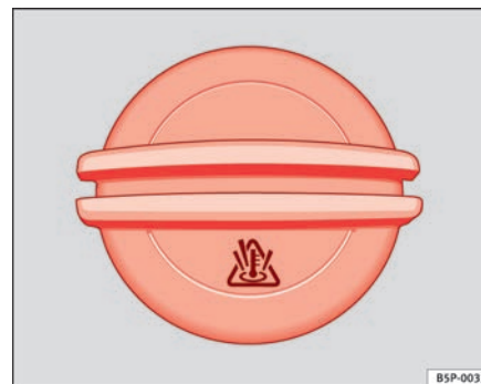
Fig. 172 En el vano motor: Tapón del depósito de expansión del líquido refrigerante.
