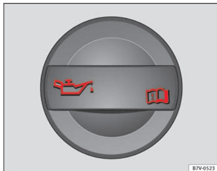
Fig. 169 En el vano motor: Tapón de la boca de llenado del aceite del motor.
