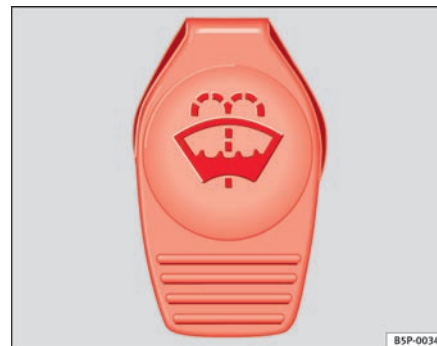
Fig. 71 En el vano motor: tapón del depósito del lavacristales.
