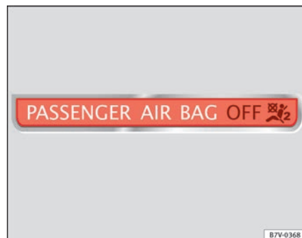
Fig. 16 Testigo de control en el tablero de instrumentos para la desactivación del airbag frontal del acompañante.
