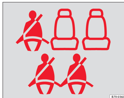
Fig. 4 Ejemplo de indicación del estado del cinturón en las plazas traseras (aquí, en un vehículo de 7 plazas) en el cuadro de instrumentos: arriba, la segunda hilera; abajo, la tercera hilera de asientos.
