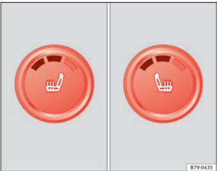
Fig. 79 Detalle de la consola central: mandos para la calefacción de los asientos delanteros, aquí con el segundo nivel de temperatura ajustado.
