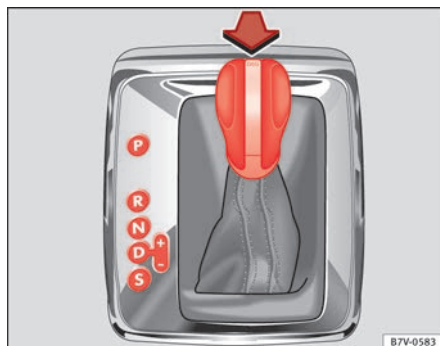
Fig. 131 Vehículos con volante a la izquierda: Palanca selectora del cambio automático con tecla de bloqueo (flecha).
