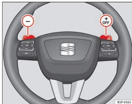
Fig. 134 Volante con dos levas para el Tiptronic.
