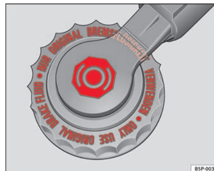
Fig. 137 En el vano motor: tapón del depósito del líquido de frenos
