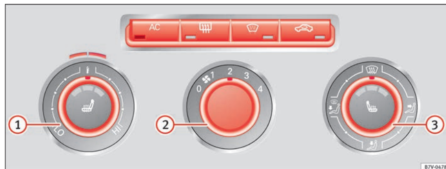
Fig. 121 Detalle de la consola central: Mandos del Climatic.
