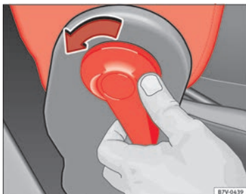
Fig. 160 Desbloquear el respaldo abatible del asiento del acompañante.
