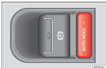
Fig. 206 Detalle de la consola central: tecla del Auto Hold.
