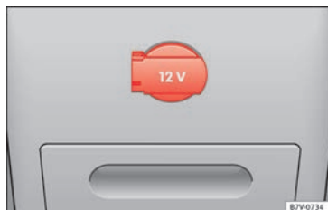
Fig. 193 Parte posterior de la consola central: toma de corriente de 12 voltios.
