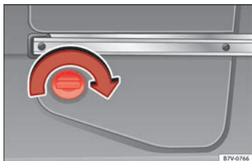
Fig. 238 En la parte trasera izquierda del maletero: depósito de AdBlue, detrás de una cubierta.
