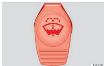
Fig. 58 En el vano motor: tapón del depósito del limpiacristales.
