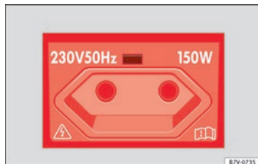
Fig. 194 Detalle de la consola central trasera: toma de corriente europea de 230 voltios.
