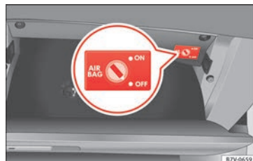
Fig. 92 En la guantera, en el lado del acompañante: interruptor de llave para activar y desactivar el airbag frontal del acompañante.
