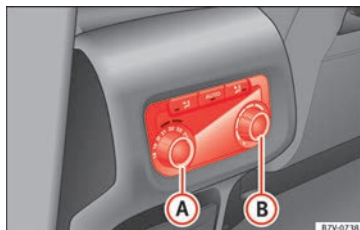
Fig. 195 Consola central: detalle de los mandos en las plazas traseras.
