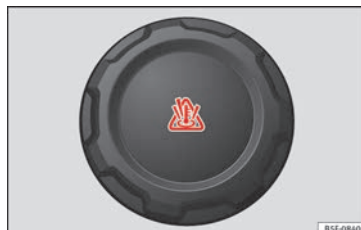
Fig. 247 En el vano motor: Tapón del depósito de expansión del líquido refrigerante.
