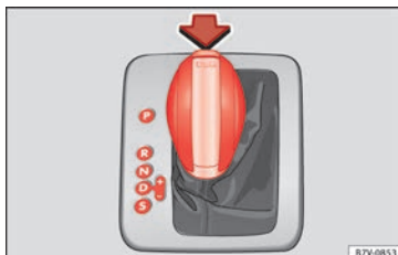
Fig. 202 Palanca selectora del cambio automático con tecla de bloqueo (flecha).
