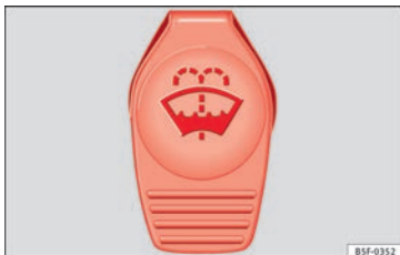
Fig. 249 En el vano motor: tapón del depósito del lavacristales.
