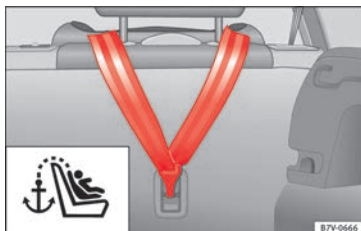
Fig. 38 Cinturón de fijación superior enganchado en el maletero.
