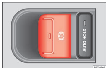
Fig. 201 Detalle de la consola central: comutador del freno de estacionamiento electrónico.
