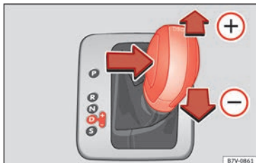
Fig. 203 Palanca selectora en la posición Tiptronic (vehículos con volante a la izquierda). Los vehículos con el volante a la derecha están dispuestos de forma simétrica.
