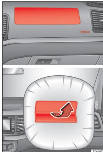
Fig. 26 Ubicación y campo de acción del airbag frontal del acompañante.
