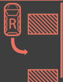
Fig. 214 Hueco detectado: coloque la marcha atrás para aparcar (en línea o en batería).
