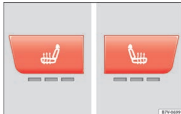
Fig. 155 Detalle de la consola central: mandos para la calefacción de los asientos delanteros en vehículos equipados con Climatronic.
