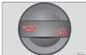
Fig. 55 Tapón de la boca de llenado de aceite del motor en el vano motor.
