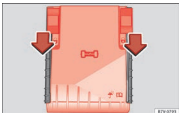
Fig. 60 En el vano motor: tapa de la caja de fusibles.
