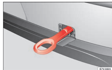
Fig. 104 En el parachoques trasero, en el lado derecho: Argolla de remolque enroscada.
