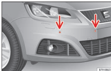
Fig. 209 Sensores del control de la distancia de aparcamiento en el paragolpes delantero.
