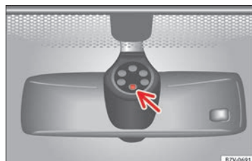
Fig. 145 Superficie sensible del sensor de lluvia.
