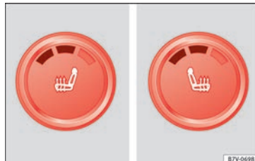
Fig. 154 Detalle de la consola central: mandos para la calefacción de los asientos delanteros, aquí con el segundo nivel de temperatura ajustado.
