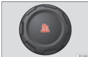
Fig. 56 Vano motor: tapón del depósito de expansión del líquido refrigerante.
