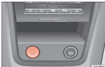
Fig. 199 En la consola central: pulsador de arranque del sistema de cierre y arranque sin llave Keyless Access. En los vehículos con el volante a la derecha, la disposición es simétrica.
