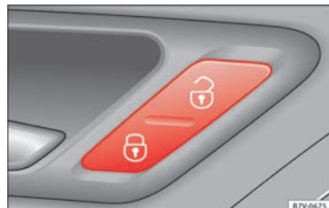
Fig. 130 En la puerta del conductor: botón del cierre centralizado.
