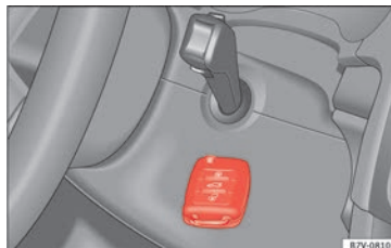
Fig. 200 Arranque de emergencia en vehículos con Keyless Access.
