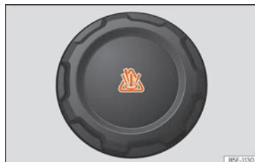
Fig. 295 En el vano motor: Tapón del depósito de expansión del líquido refrigerante.
