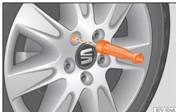
Fig. 73 Cambio de rueda: aflojar los tornillos de la rueda con el mango del destornillador.
