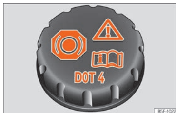
Fig. 296 En el vano motor: tapón del depósito del líquido de frenos.
