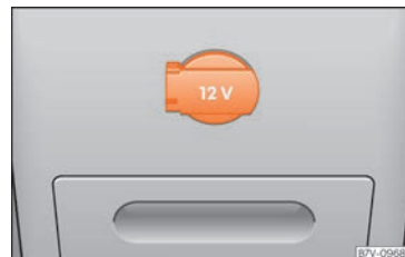
Fig. 197 Parte posterior de la consola central: toma de corriente de 12 voltios.
