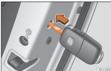
Fig. 7 Bloqueo de emergencia del vehículo con la llave del vehículo.
