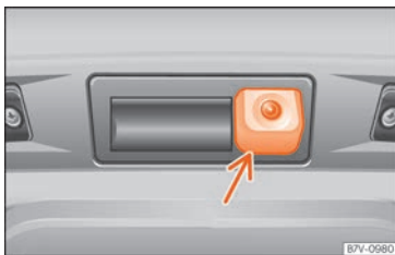
Fig. 253 En el portón trasero: ubicación de la cámara del asistente para marcha atrás.
