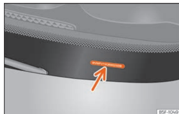
Fig. 304 Número de identificación del vehículo.
