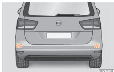
Fig. 272 Vista trasera del vehículo: zonas de los sensores de radar.
