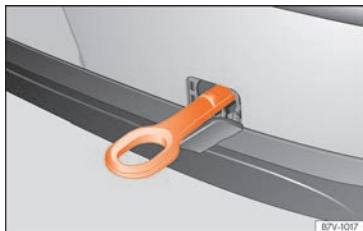
Fig. 106 En el parachoques trasero, en el lado derecho: Argolla de remolque enroscada.
