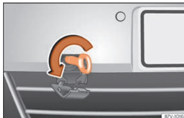
Fig. 105 En la parte derecha del parachoques delantero: enroscar la argolla de remolque.
