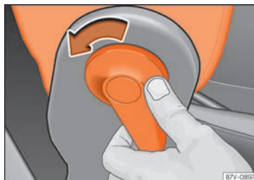
Fig. 164 Desbloquear el respaldo abatible del asiento del acompañante.
