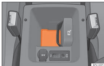
Fig. 124 Reposabrazos central delantero: alojamiento para la conexión del teléfono móvil a la antena exterior del vehículo.
