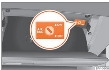
Fig. 94 En la guantera, en el lado del acompañante: interruptor de llave para activar y desactivar el airbag frontal del acompañante.
