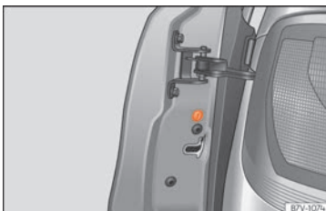
Fig. 6 En la parte frontal de la puerta corrediza: bloqueo de emergencia, oculto por una junta de goma.
