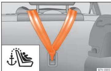
Fig. 40 Cinturón de fijación superior enganchado en el maletero.
