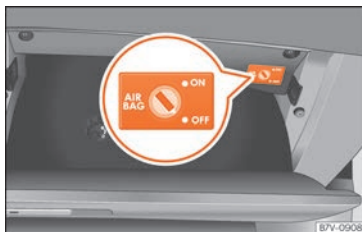
Fig. 29 En la guantera, en el lado del acompañante: interruptor de llave para activar y desactivar el airbag frontal del acompañante.
