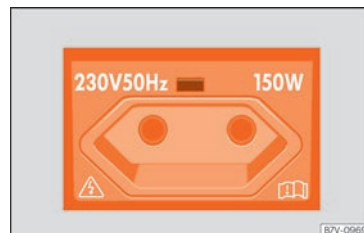
Fig. 198 Detalle de la consola central trasera: toma de corriente europea de 230 voltios.
