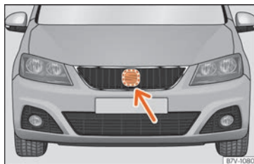
Fig. 259 En el frontal tras el emblema de SEAT: sensor de radar.
