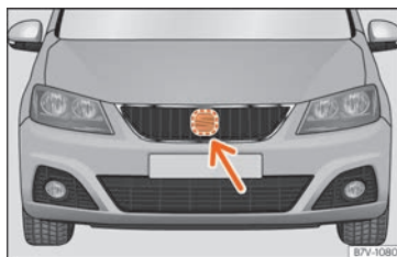
Fig. 263 En el frontal tras el emblema de SEAT: sensor de radar.
