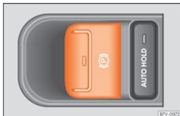
Fig. 239 Detalle de la consola central: conmutador del freno de estacionamiento electrónico.
