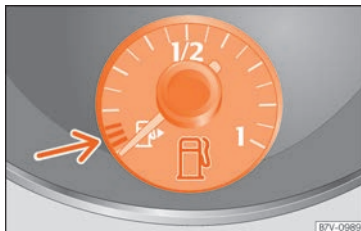
Fig. 285 En el cuadro de instrumentos: indicador del nivel de combustible para gasolina y diésel.
