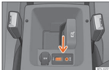
Fig. 218 Reposabrazos central delantero: entrada USB/AUX-IN.
