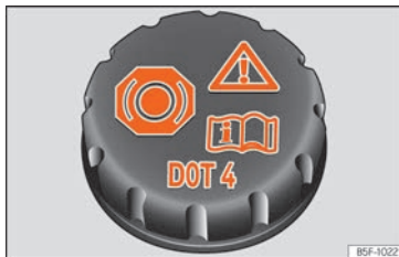
Fig. 59 Vano motor: tapón del depósito del líquido de frenos.
