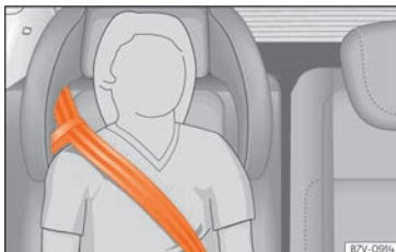
Fig. 98 Asiento integrado para niños: recorrido de la banda del cinturón con asa-guía.
