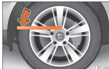
Fig. 69 Cambio de rueda: afloje los tornillos de la rueda.
