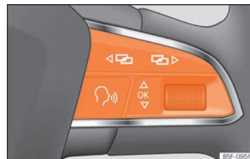
Fig. 82 Volante multifunción: teclas para utilizar los menús del cuadro de instrumentos.
