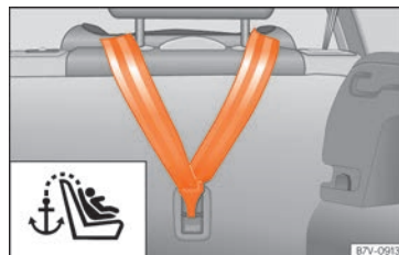
Fig. 31 Parte posterior de los asientos traseros: argollas de sujeción para el cinturón Top Tether.
