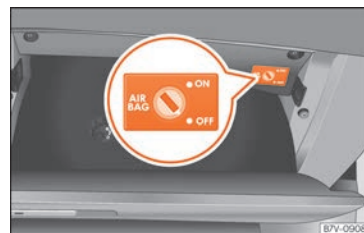
Fig. 18 En la guantera, en el lado del acompañante: interruptor de llave para activar y desactivar el airbag frontal del acompañante.
