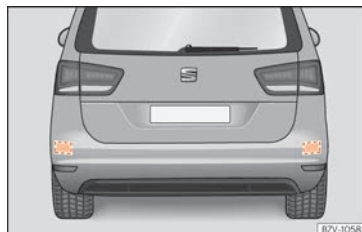
Fig. 260 Vista trasera del vehículo: zonas de los sensores de radar.
