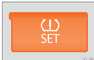
Fig. 297 Consola central: tecla del indicador de la presión de los neumáticos.
