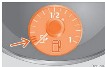
Fig. 78 En el cuadro de instrumentos: indicador del nivel de combustible para gasolina y diésel.
