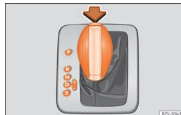
Fig. 238 Palanca selectora del cambio automático con tecla de bloqueo (flecha).
