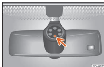
Fig. 122 Superficie sensible del sensor de lluvia.
