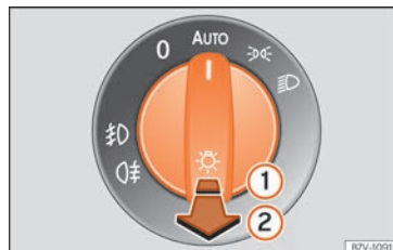
Fig. 115 Tablero de instrumentos: mando de las luces.
