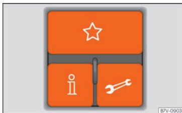
Fig. 85 Módulo de tres teclas del techo: mandos del sistema de gestión del teléfono.
