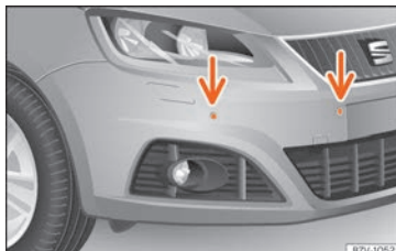
Fig. 271 Sensores del control de aparcamiento en el paragolpes delantero.
