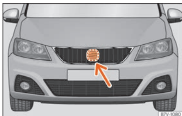
Fig. 251 En el frontal tras el emblema de SEAT: sensor de radar.
