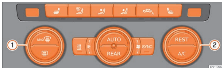
Fig. 173 En la consola central: mandos del Climatronic.
