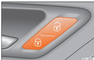
Fig. 90 Puerta del conductor: conmutador del cierre centralizado.
