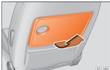
Fig. 163 Mesita plegable en el asiento delantero.
