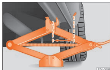
Fig. 48 Gato colocado en la parte trasera izquierda del vehículo.
