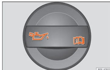
Fig. 289 Tapón de la boca de llenado de aceite del motor en el vano motor.
