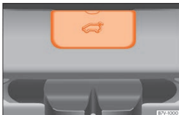
Fig. 107 Detalle del maletero: acceso al desbloqueo de emergencia.
