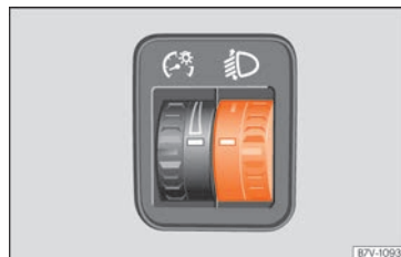
Fig. 118 Al lado del volante: regulador del alcance de las luces.
