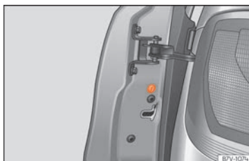
Fig. 96 En la parte frontal de la puerta corrediza: bloqueo de emergencia, oculto por una junta de goma.
