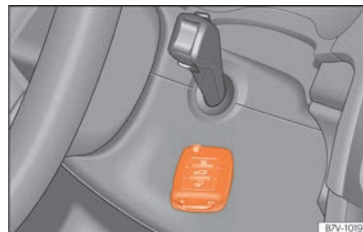
Fig. 235 Arranque de emergencia en vehículos con Keyless Access.
