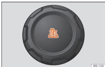
Fig. 291 Vano motor: tapón del depósito de expansión del líquido refrigerante.
