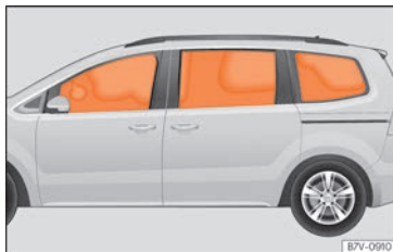
Fig. 25 Airbags para la cabeza inflados.
