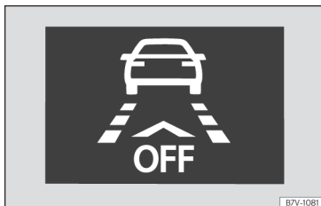
Fig. 248 En la pantalla del cuadro de instrumentos: indicación de Front Assist desactivado.
