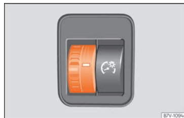
Fig. 119 Al lado del volante: regulador de la iluminación de los instrumentos y los mandos
