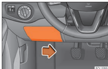
Fig. 58 En el tablero de instrumentos del lado del conductor: tapa de la caja de fusibles.
