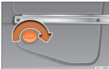
Fig. 283 En la parte trasera izquierda del maletero: depósito de AdBlue, detrás de una cubierta.
