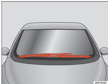
Fig. 169 Limpiacristales en la posición para realizar el cambio
