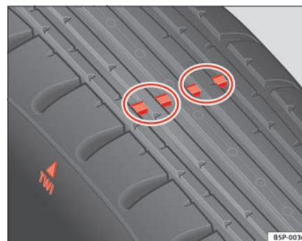
Fig. 173 Indicadores de desgaste del perfil del neumático
