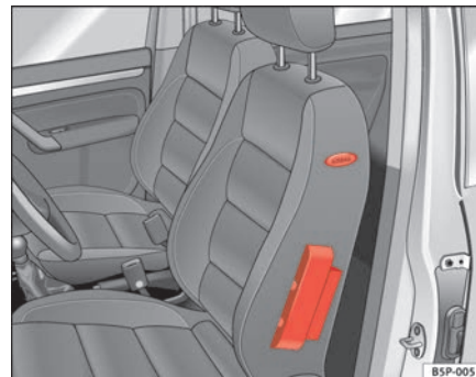
Fig. 22 Airbag lateral en el asiento del conductor
