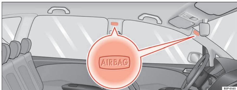
Fig. 24 Ubicación de los airbags para la cabeza en el lado izquierdo del vehículo
