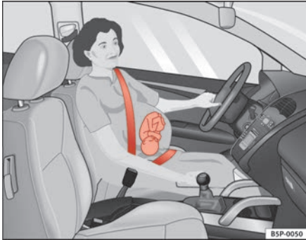
Fig. 15 Colocación de la banda del cinturón en el caso de mujeres embarazadas
