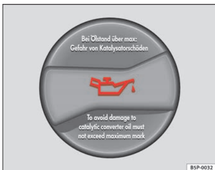
Fig. 166 Tapón de la boca de llenado de aceite del motor en el vano motor
