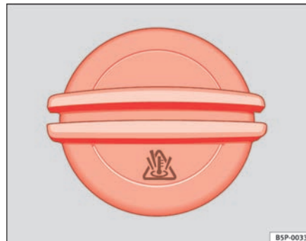
Fig. 167 Tapón del depósito de expansión del líquido refrigerante en el vano motor
