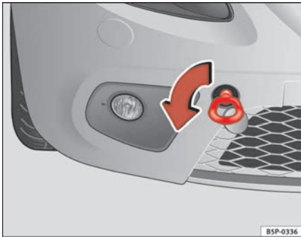
Fig. 207 Argolla de remolque delantera para vehículos con tracción total
