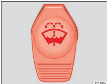
Fig. 168 Tapón del depósito del lavacristales en el vano motor.
