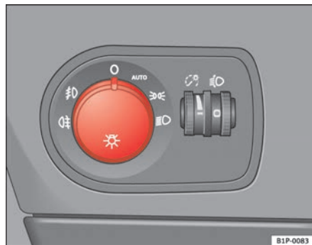
Fig. 74 Encendido automático de luces
