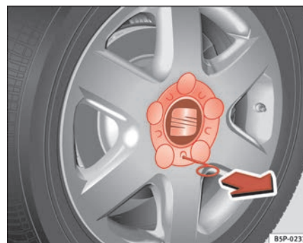
Fig. 176 Cambio de rueda: Retirar el embellecedor de la rueda
