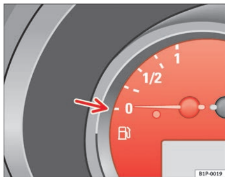
Fig. 34 Cuadro de instrumentos: indicador de nivel del depósito de combustible
