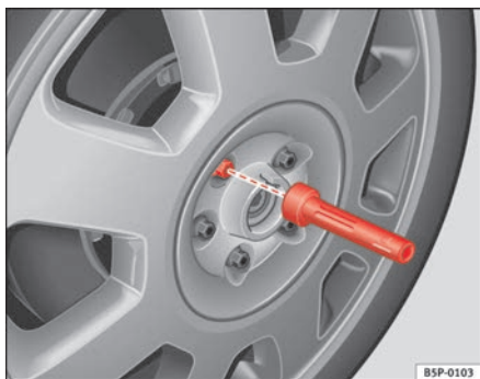
Fig. 181 Cambio de rueda: Útil de hexágono interior para girar los tornillos
