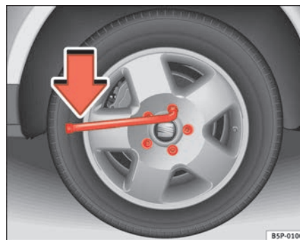
Fig. 177 Cambio de rueda: aflojar los tornillos de rueda
