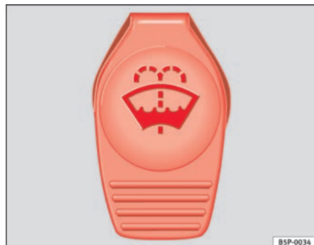
Fig. 162 Tapón del depósito del lavacristales en el vano motor.
