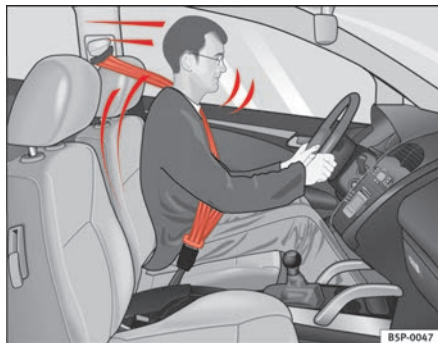
Fig. 11 Conductor con el cinturón de seguridad bien puesto: es sujetado por el mismo en un frenazo brusco
