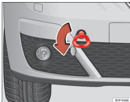
Fig. 200 Atornillado de la argolla de remolque en la parte delantera derecha del vehículo
