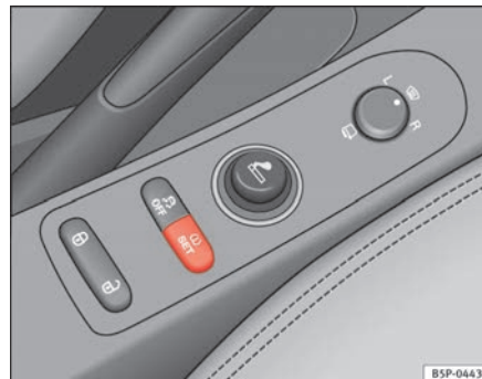
Fig. 49 Consola central: tecla del sistema de control de los neumáticos ►
