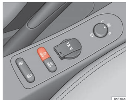
Fig. 137 Detalle de la consola central: tecla ESP
