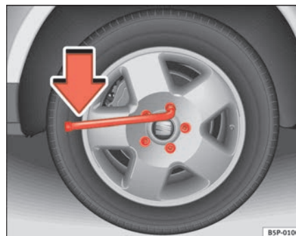
Fig. 172 Cambio de rueda: aflojar los tornillos de rueda
