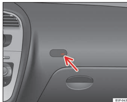
Fig. 27 Testigo de control de la desactivación del airbag del acompañante
