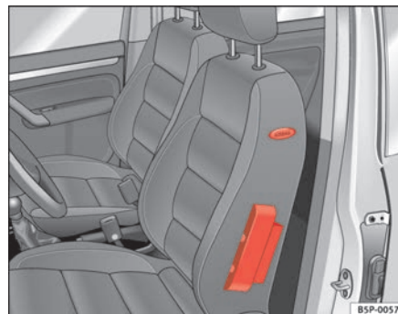
Fig. 22 Airbag lateral en el asiento del conductor
