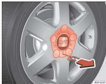
Fig. 170 Cambio de rueda: Retirar el embellecedor de la rueda
