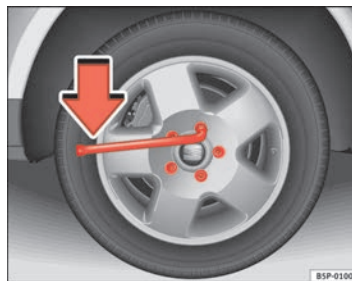
Fig. 171 Cambio de rueda: aflojar los tornillos de rueda
