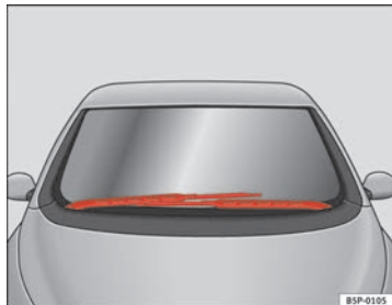
Fig. 162 Limpiacristales en la posición para realizar el cambio
