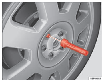
Fig. 175 Cambio de rueda: Útil de hexágono interior para girar los tornillos
