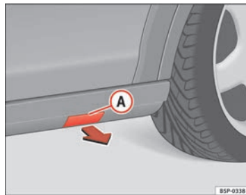
Fig. 174 Talonera de plástico con tapa para anclaje de gato
