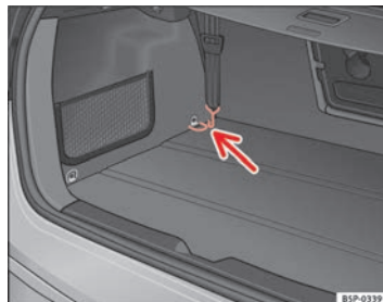
Fig. 126 Argollas de amarre para tensar la red separadora
