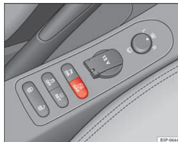
Fig. 136 Consola central: conmutador de control del sistema de gas.
