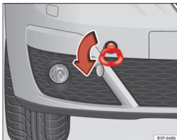
Fig. 203 Atornillado de la argolla de remolque en la parte delantera derecha del vehículo
