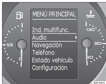
Fig. 48 Pantalla digital del cuadro de instrumentos: Menú principal
