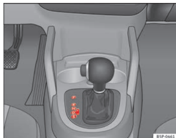
Fig. 141 Consola central: palanca selectora del cambio automático / cambio automático DSG
