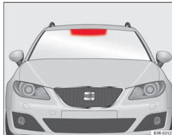
Fig. 173 Área de ubicación del telepeaje
