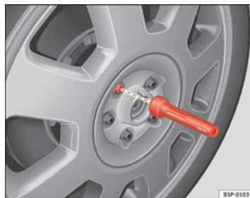
Fig. 198 Cambio de rueda: Útil de hexágono interior para girar los tornillos
