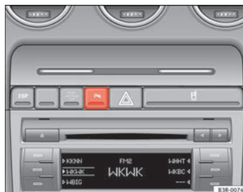
Fig. 150 Consola central: interruptor para ayuda de aparcamiento
