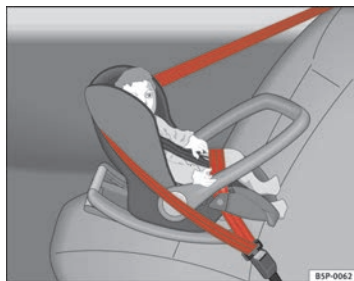
Fig. 29 Asiento para niños del grupo 0 en el asiento trasero, colocado en el sentido contrario a la dirección de la marcha.
