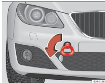
Fig. 244 Atornillado de la argolla de remolque en la parte delantera del vehículo
