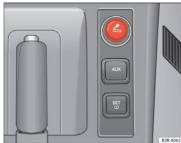
Fig. 135 Encendedor en la consola central
