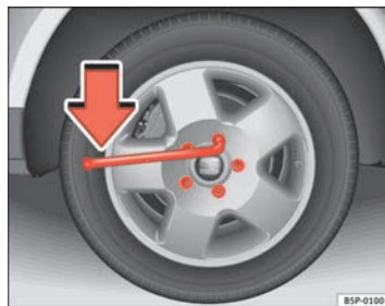
Fig. 195 Cambio de rueda: Aflojar los tornillos de la rueda
