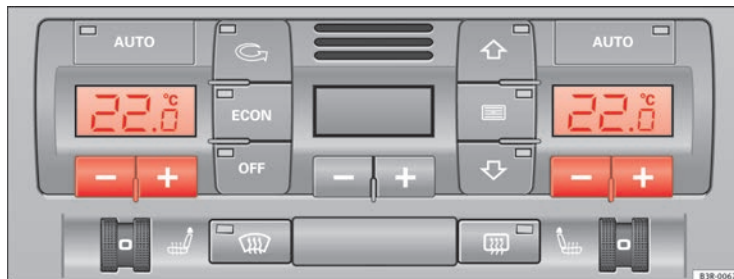
Fig. 141 Mandos del climatizador
