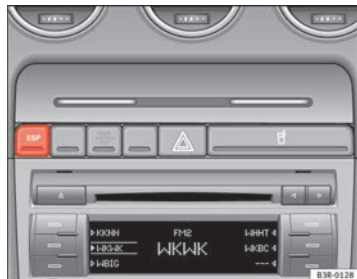
Fig. 146 Detalle de la consola central: tecla ESP
