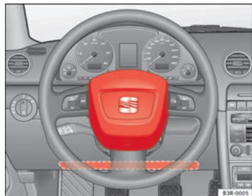
Fig. 17 Airbag del conductor en el volante y airbag de rodillas en el tablero de instrumentos
