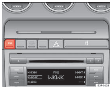
Fig. 149 Consola central con el interruptor del ESP
