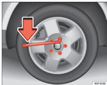
Fig. 179 Cambio de rueda: Aflojar los tornillos de la rueda
