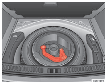
Fig. 151 Maletero: Rueda de repuesto con dispositivo para remolque
