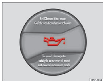
Fig. 167 Tapón de la boca de llenado de aceite del motor en el vano motor
