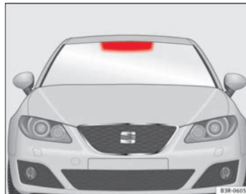
Fig. 162 Área de ubicación del telepeaje
