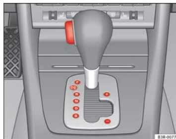
Fig. 143 Detalle de la consola central: Palanca selectora con tecla de bloqueo
