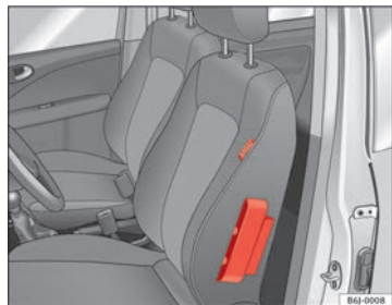
Fig. 23 Airbag lateral en el asiento del conductor
