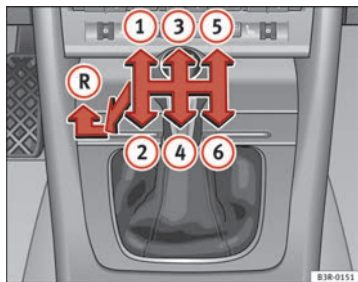
Fig. 142 Detalle de la consola central: esquema de un cambio manual de 6 marchas
