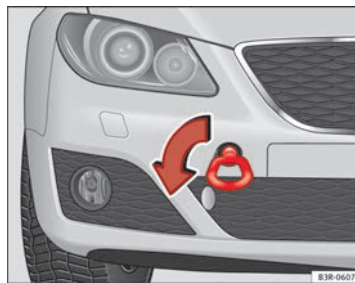
Fig. 227 Atornillado de la argolla de remolque en la parte delantera del vehículo
