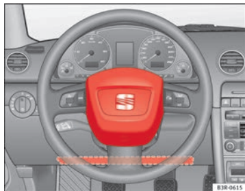
Fig. 18 Airbag del conductor en el volante y airbag de rodillas en el tablero de instrumentos
