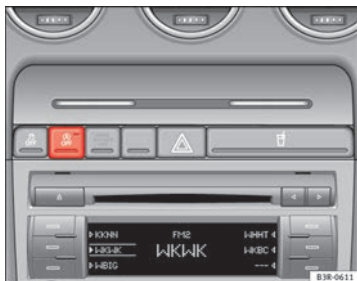
Fig. 148 Detalle del pulsador del funcionamiento Start-Stop.
