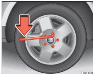
Fig. 197 Cambio de rueda: Aflojar los tornillos de la rueda
