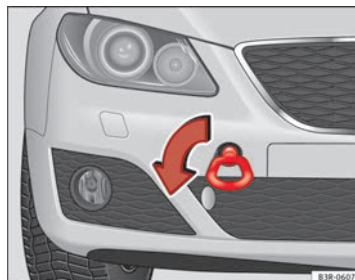
Fig. 247 Atornillado de la argolla de remolque en la parte delantera del vehículo
