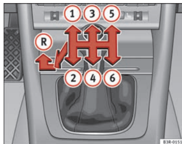
Fig. 157 Detalle de la consola central: esquema de un cambio manual de 6 marchas
