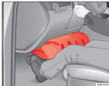
Fig. 23 Los airbags hinchados protegen en una colisión frontal
