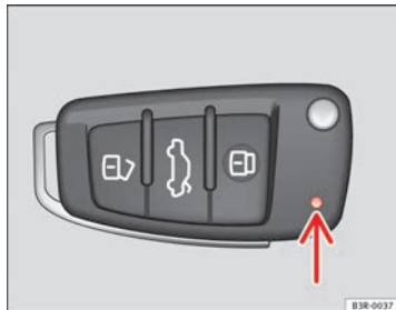
Fig. 69 Diodo luminoso en la llave de control remoto
