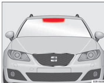
Fig. 177 Área de ubicación del telepeaje
