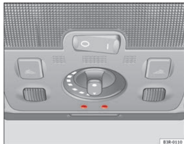
Fig. 94 Detalle del revestimiento del techo: Iluminación ambiental
