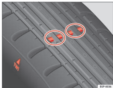
Fig. 191 Indicadores de desgaste del perfil del neumático
