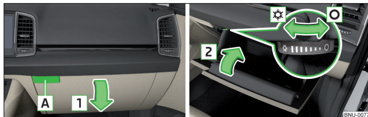
Fig. 113 Operar el compartimento guardabojos / Cerrar el compartimento guardabojos y operar el suministro de aire
