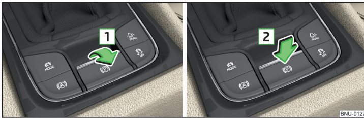
Fig. 245 Operar el freno de estacionamiento
