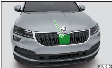
Fig. 253 Lugar de instalación del sensor de radar
