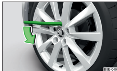
Fig. 318 Aflojar los tornillos de rueda
