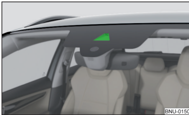
Fig. 290 Sensor para el reconocimiento de las señales de tráfico
