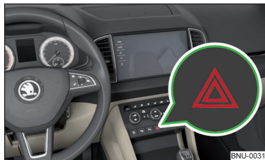
Fig. 66 Tecla para el sistema de intermitentes simultáneos
