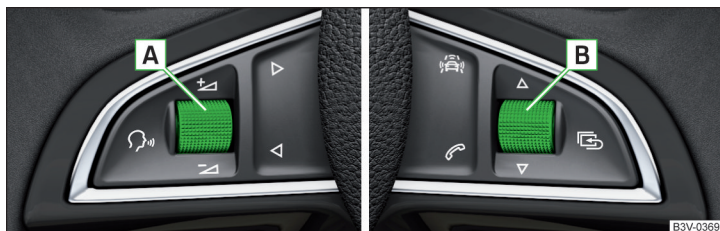
Fig. 42 Teclas/ruedas de ajuste en el volante multifuncional
