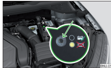
Fig. 307 Batería del vehículo: Indicador del nivel de ácido
