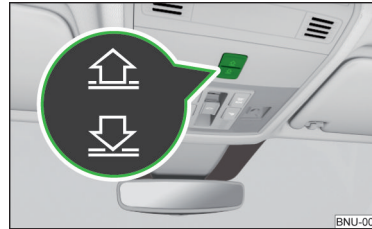
Fig. 60 Tecla para manejar la cortinilla antisolar
