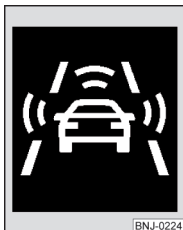
Fig. 285 Pantalla del cuadro de instrumentos combinado: Advertencia previa o frenado de emergencia en baja velocidad
