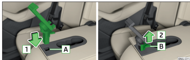
Fig. 129 Colocar el soporte / Retirar el soporte
