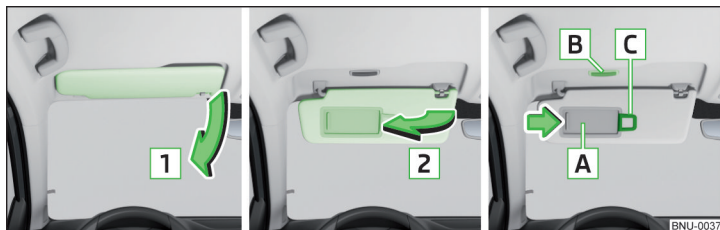
Fig. 73 Bajar visera / subir visera / espejo de maquillaje con luz y porta-etiquetas de aparcamiento
