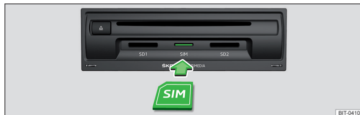
Fig. 193 Introducir la tarjeta SIM en el módulo externo
