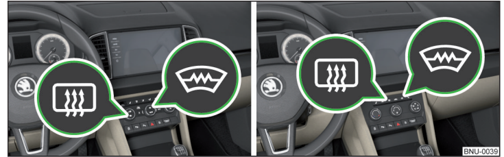
Fig. 72 Teclas para la calefacción del parabrisas y la luneta posterior: Climatronic / Aire acondicionado manual
