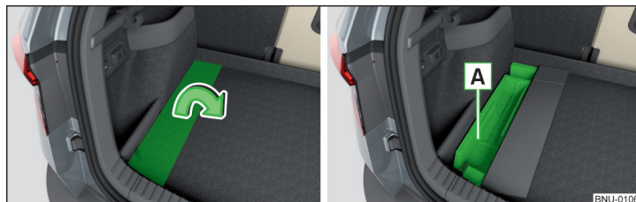
Fig. 146 Variante 1: Abatir hacia atrás la moqueta / Compartimento guardaobjetos debajo de la moqueta
