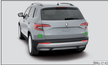
Fig. 262 Lugar de instalación de los sensores de radar
