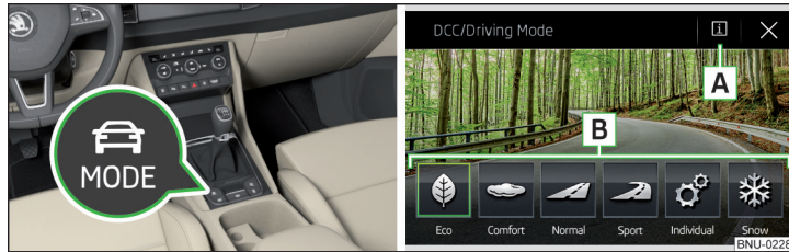
Fig. 286 Tecla para la selección del modo de conducción / Visualización en la pantalla Infotainment
