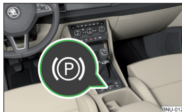
Fig. 244 Tecla del freno de estacionamiento
