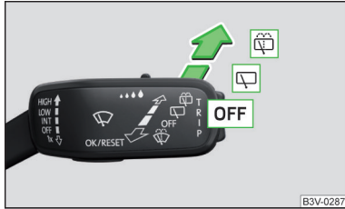
Fig. 75 Manejo de los limpiaparabrisas y lavaparabrisas
