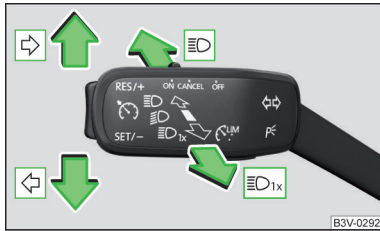
Fig. 62 Palanca de mando: Manejo de intermitente y luz de carretera
