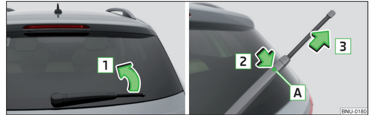
Fig. 335 Reemplazar la escobilla limpiacristales de la luna trasera
