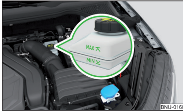
Fig. 306 Depósito del líquido de frenos
