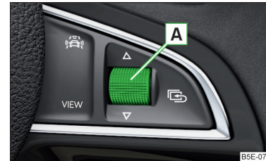
Fig. 35 Teclas/rueda de ajuste en el volante multifuncional
