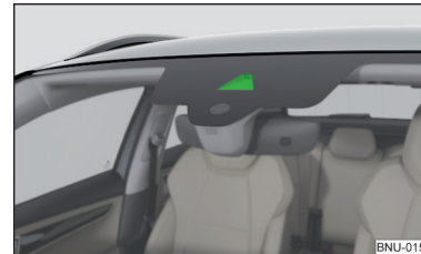
Fig. 287 Sensor para Lane Assist
