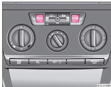
Fig. 65 Cuadro de interruptores: Regulador giratorio para el calefactado de los asientos delanteros
