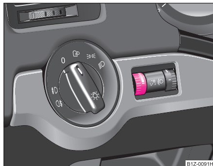
Fig. 44 Cuadro de interruptores: Iluminación de los instrumentos
