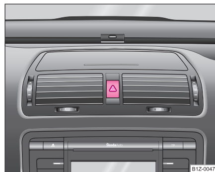
Fig. 46 Cuadro de interrutores: Interruptor para el sistema de intermitentes simultáneos
