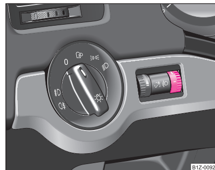
Fig. 45 Cuadro de interruptores: Regulación del alcance luminoso de los faros
