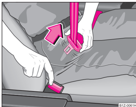
Fig. 155 Retirar la lengüeta del cierre del cinturón
