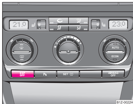
Fig. 175 Interruptor del ESP
