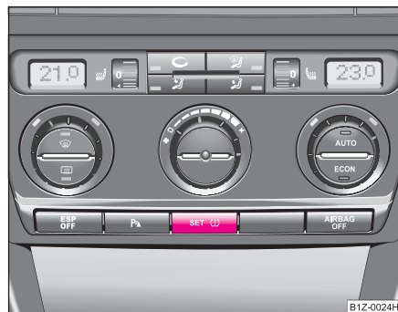
Fig. 177 Pulsador para ajustar el valor de control de la presión de inflado de los neumáticos
