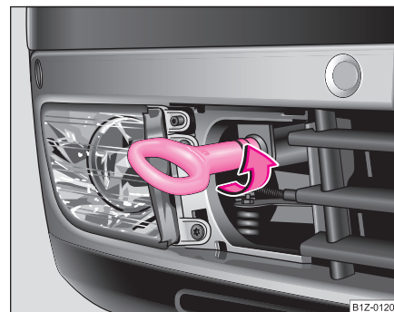
Fig. 209 Paragolpes delantero: montaje de la argolla de remolque ▶
