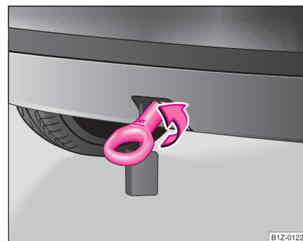
Fig. 211 Paragolpes trasero: montaje de la argolla de remolque
