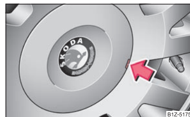
Fig. 136 Retirar el embellecedor de rueda en ruedas de aleación ligera
