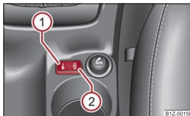
Fig. 25 Consola central: Teclas para cierre centralizado
