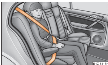
Fig. 108 Asiento infantil del grupo 3 montado en el sentido de marcha sobre el asiento trasero
