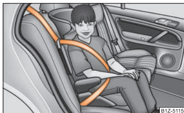
Fig. 107 Asiento infantil del grupo 2 montado en el sentido de marcha sobre el asiento trasero
