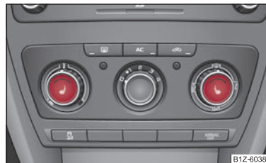
Fig. 54 Cuadro de interruptores: Regulador de la calefacción de asientos delanteros
