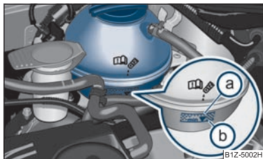
Fig. 124 Vano motor: Depósito de expansión de líquido refrigerante
