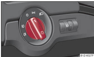
Fig. 34 Cuadro de interruptores: Conmutador luz
