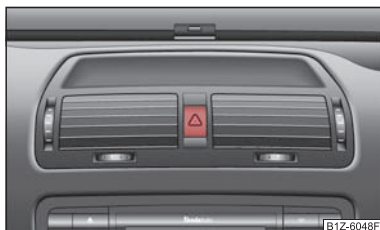
Fig. 37 Cuadro de interruptores: Interruptor para el sistema de intermitentes simultáneos
