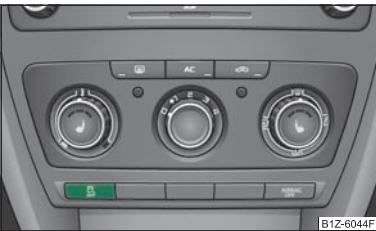
Fig. 111 Interruptor del ESP
