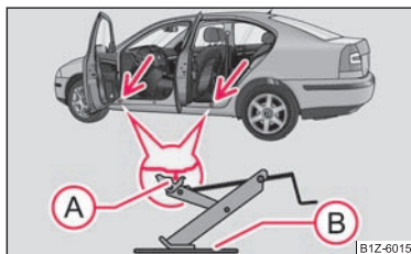
Fig. 138 Cambio de rueda: Puntos de apoyo del gato
