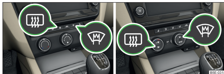
Fig. 58 Teclas para la calefacción del parabrisas y la luneta trasera aire acondicionado manual, calefacción / Climatronic
