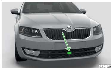
Fig. 150 Lugar de montaje del sensor de radar
