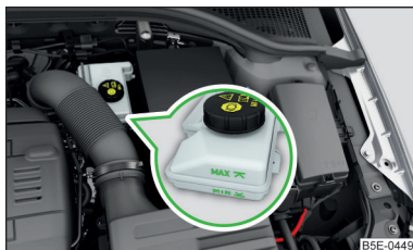
Fig. 182 Vano motor: depósito del líquido de frenos
