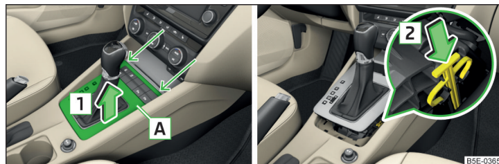
Fig. 211 Desbloqueo de emergencia de la palanca selectora
