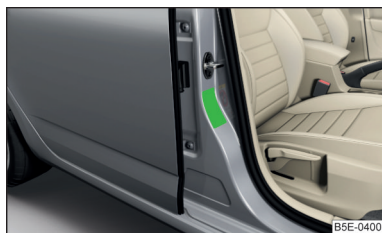
Fig. 15 Adhesivo en el montante B en el lado del acompañante
