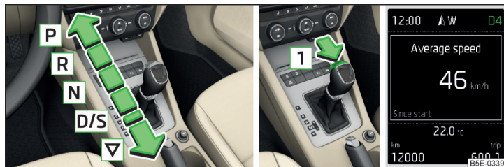
Fig. 131 Palanca selectora / tecla de bloqueo / indicador de pantalla
