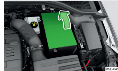
Fig. 183 Vano motor: cubierta de poliéster de la batería del vehículo
