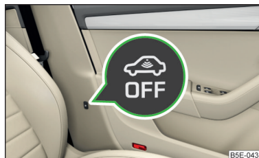
Fig. 38 Tecla para la vigilancia del habitáculo y la protección contra remolcado
