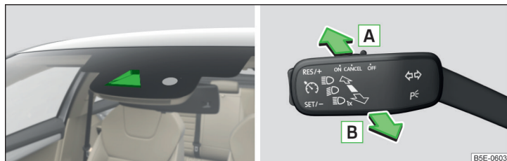
Fig. 49 Encender/apagar ventanilla del sensor para el asistente de luz de carretera / sistema
