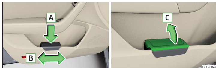
Fig. 82 Cubo de basura: colocar y mover / abrir
