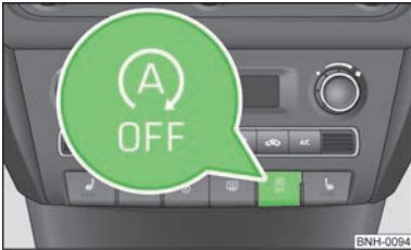
Fig. 69 Cuadro de interruptores: Tecla para el sistema ARRANQUE-PARADA
