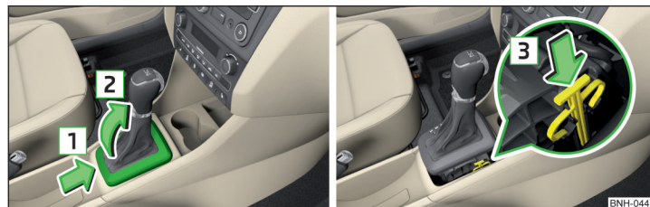
Fig. 172 Desbloqueo de emergencia de la palanca selectora
