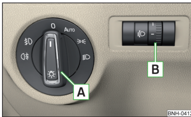
Fig. 44 Conmutador de luces y regulador giratorio para la regulación del alcance luminoso
