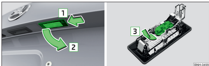
Fig. 186 Desmontar la luz de la matrícula / cambiar la bombilla
