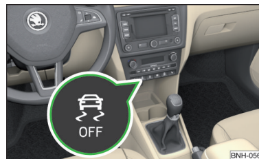
Fig. 114 Tecla del sistema: Activar/desactivar ASR
