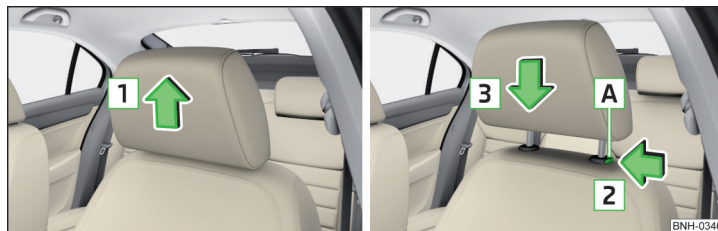
Fig. 58 Reposacabezas: mover hacia arriba / hacia abajo
