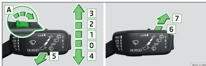
Fig. 54 Operación del limpiaparabrisas y lavaparabrisas delantero / trasero
