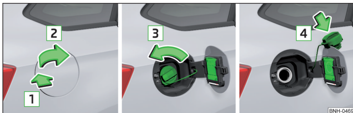
Fig. 142 Abrir la tapa del depósito/ desenroscar el cierre del depósito/ colocar el cierre del depósito en la tapa del depósito
