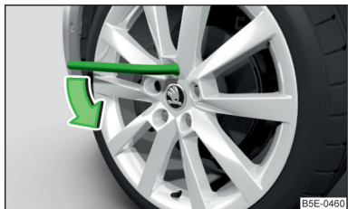
Fig. 160 Cambio de rueda: aflojar los tornillos de rueda
