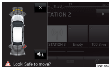
Fig. 119 Pantalla del Infotainment: Visualización en la activación automática
