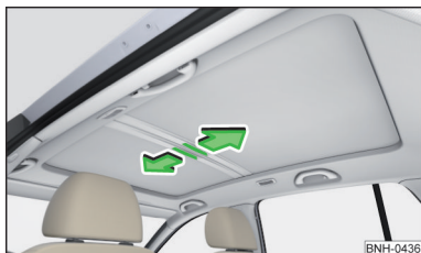
Fig. 53 Abrir la cortinilla antisolar enrollable
