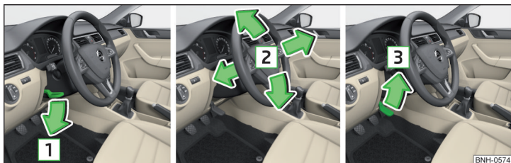
Fig. 2 Ajustar la posición del volante
