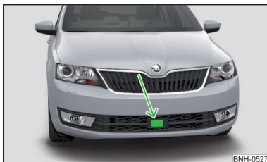
Fig. 123 Lugar de montaje del sensor de radar
