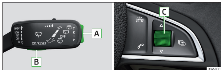
Fig. 27 Teclas/Rueda de ajuste: en la palanca de mando / en el volante multifunción
