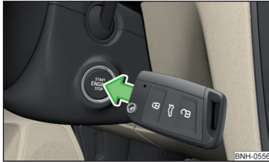
Fig. 104 Dejar el motor encendido - Presionar el botón con la llave
