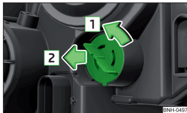
Fig. 184 Cambiar la bombilla para luz intermitente delantera
