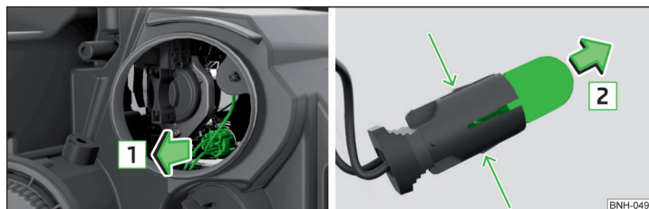
Fig. 183 Cambiar la bombilla de la luz de población
