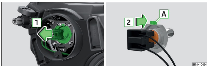
Fig. 181 cambiar la bombilla de la luz de cruce
