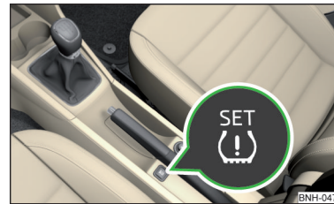
Fig. 128 Tecla para guardar los valores de presión
