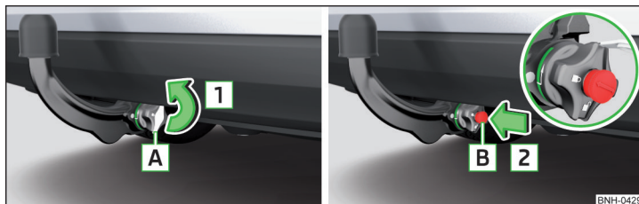
Fig. 136 Retire la tapa de la cerradura/introduzca la llave en la cerradura
