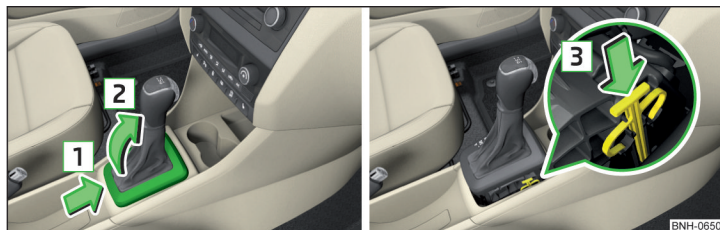
Fig. 265 Retirar la tapa / desbloquear la palanca selectora
