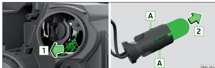
Fig. 277 Cambiar la bombilla de la luz de población
