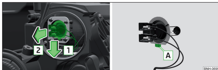
Fig. 280 Cambiar la bombilla de la luz de carretera.
