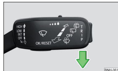
Fig. 266 Ajustar la posición de servicio de los brazos del parabrisa
