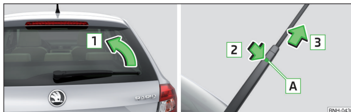
Fig. 268 Reemplazar la escobilla limpiacristales de la luna trasera
