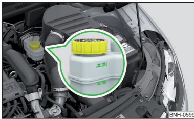
Fig. 241 depósito del líquido de frenos
