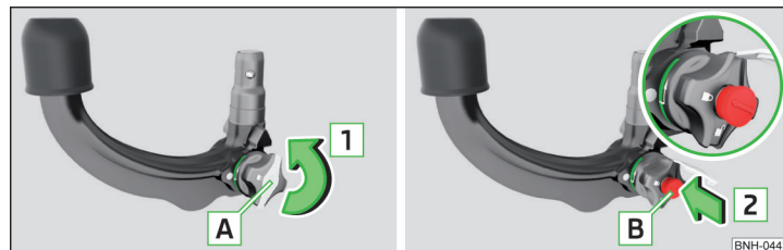
Fig. 221 Retire la tapa de la cerradura/introduzca la llave en la cerradura
