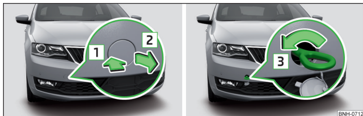
Fig. 259 Retirar la caperuza / instalar la argolla de remolque
