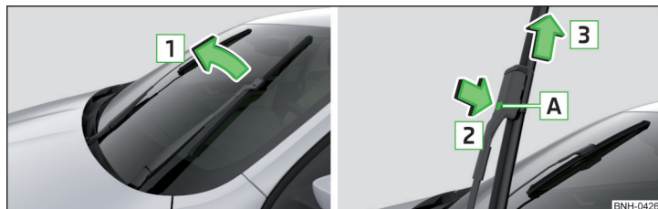
Fig. 267 Cambiar la escobilla limpiacristales del parabrisas
