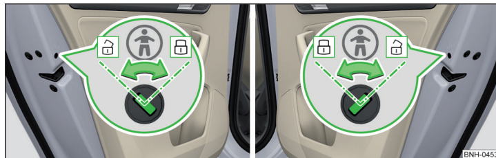
Fig. 51 Puerta posterior: Conectar/desconectar el seguro para niños
