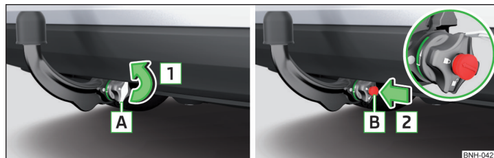
Fig. 227 Retire la tapa de la cerradura/introduzca la llave en la cerradura
