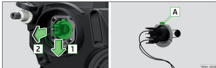
Fig. 278 Cambiar la bombilla de la luz de cruce
