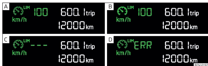
Fig. 203 Pantalla de segmentos: Ejemplos de las visualizaciones de estado del dispositivo de limitación de velocidad
