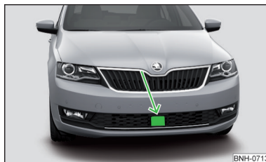
Fig. 190 Lugar de instalación del sensor de radar
