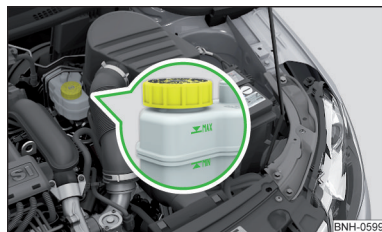
Fig. 229 depósito del líquido de frenos
