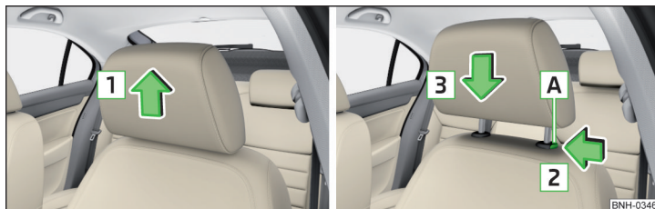
Fig. 70 Ajustar la altura del reposacabezas
