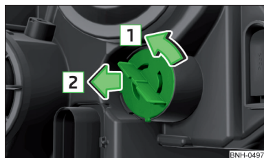
Fig. 266 Cambiar la bombilla para luz intermitente delantera
