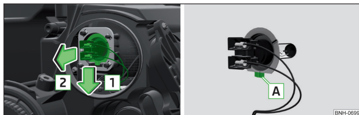
Fig. 267 Cambiar la bombilla de la luz de carretera.
