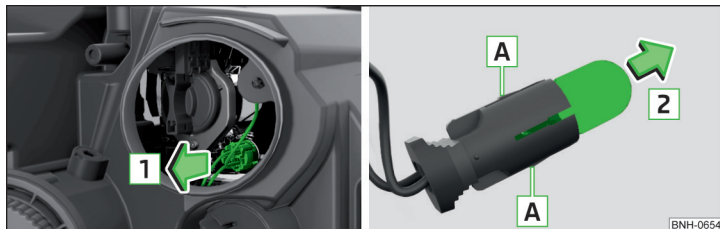
Fig. 264 Cambiar la bombilla de la luz de población
