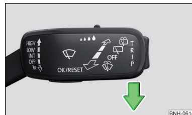
Fig. 253 Ajustar la posición de servicio de los brazos del parabrisa
