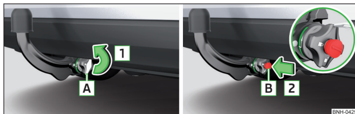
Fig. 217 Retire la tapa de la cerradura/introduzca la llave en la cerradura
