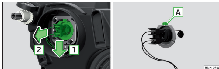
Fig. 265 Cambiar la bombilla de la luz de cruce
