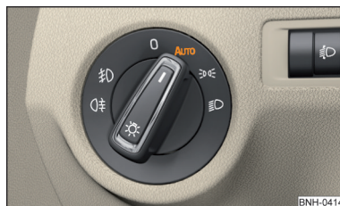
Fig. 54 Conmutador de luces: Posición AUTO
