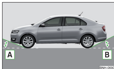
Fig. 274 Ángulo de desplome
