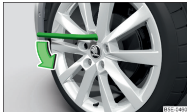
Fig. 240 aflojar los tornillos de rueda
