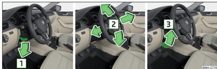
Fig. 15 Ajustar la posición del volante
