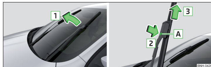
Fig. 254 Cambiar la escobilla limpiacristales del parabrisas
