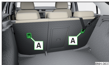
Fig. 27 Argollas de soporte del sistema TOP TETHER
