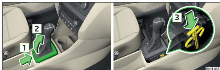
Fig. 252 Retirar la tapa / desbloquear la palanca selectora
