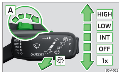
Fig. 62 Manejo de la instalación de los limpiaparabrisas y del lavado automático adelante
