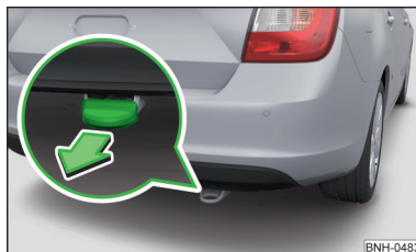
Fig. 247 Argolla de remolque trasera
