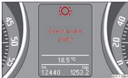
Fig. 32 Pantalla informativa: Forro de frenos desgastado
