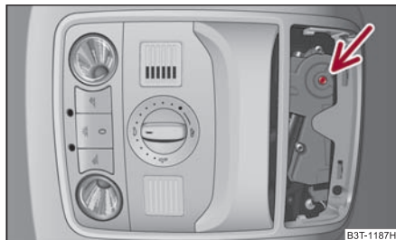
Fig. 54 Escotadura del revestimiento interior del techo: Accionamiento de emergencia
