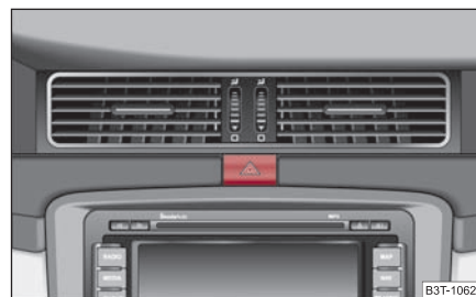
Fig. 60 Cuadro de interruptores: Interruptor para el sistema de intermitentes simultáneos
