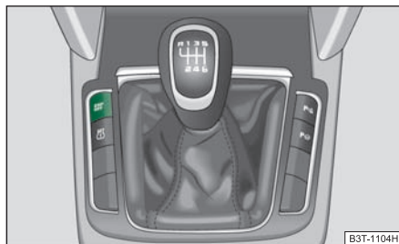
Fig. 190 Interruptor del ESP
