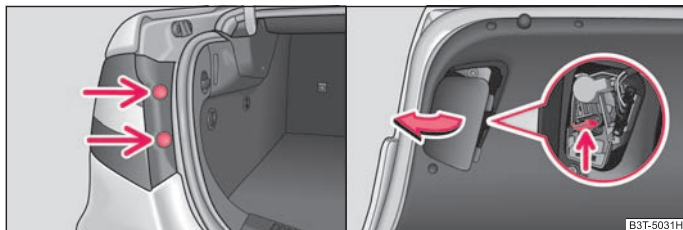
Fig. 214 Desmontaje de la parte exterior de la unidad de luces traseras / desmontaje de la parte interior de la unidad de luces traseras
