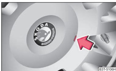
Fig. 197 Retirar el embellecedor de rueda en ruedas de aleación ligera
