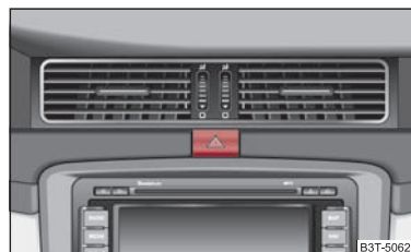
Fig. 51 Cuadro de interruptores: Interruptor para el sistema de intermitentes simultáneos
