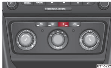
Fig. 123 Tecla de conexión/desconexión directa de la calefacción adicional (calefacción y ventilación independiente) en la unidad de mando Climatic
