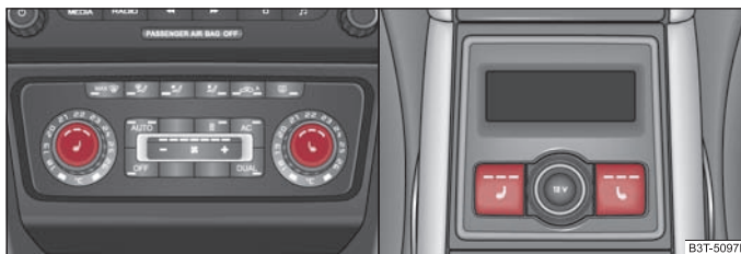
Fig. 76 Cuadro de interruptores: Regulador de la calefacción de asientos delanteros / parte trasera de la consola central: Regulador para calefacción de asientos posteriores
