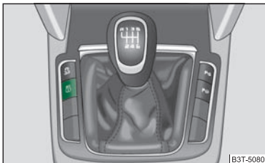
Fig. 172 Tecla para ajustar el valor de control de la presión de inflado de los neumáticos
