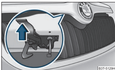
Fig. 181 Rejilla del radiador: Palanca de seguridad
