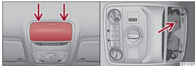
Fig. 42 Escotadura del revestimiento interior del techo: Punto de inicio del destornillador / accionamiento de emergencia
