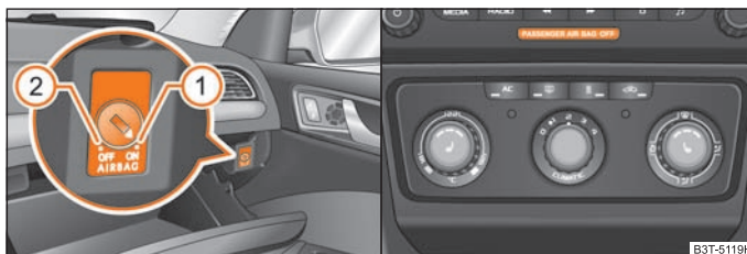
Fig. 161 Compartimento guardabojas: Conmutador para airbag frontal del acompañante / testigo para desconexión de airbag del acompañante
