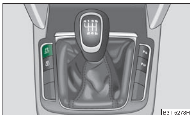
Fig. 170 Interruptor del ESP
