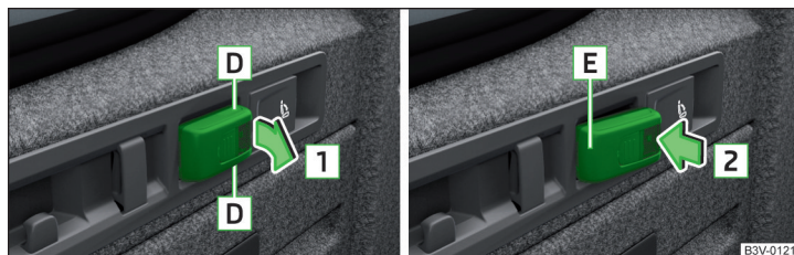
Fig. 138 Luz desmontable: Extraer/introducir
