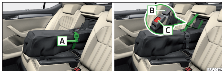
Fig. 107 Apretar banda / asegurar bolsa para carga de gran longitud
