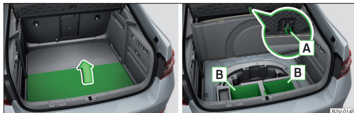
Fig. 133 Variante 1: Elevar la moqueta / Compartimentos guardaobjetos
