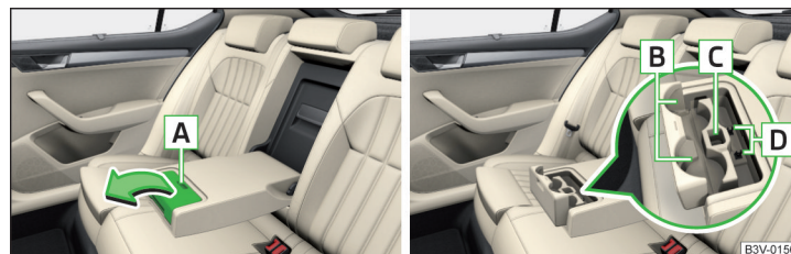
Fig. 105 Abrir el compartimento guardaobjetos/ espacio interior del compartimento
