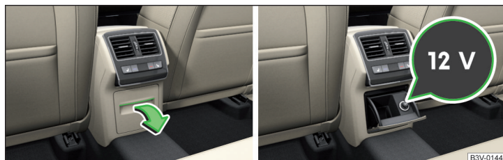
Fig. 110 Abrir el compartimento guardaobjetos / Cubierta del enchufe de 12 voltios
