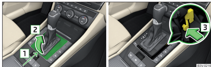
Fig. 352 Retirar la tapa / desbloquear la palanca selectora
