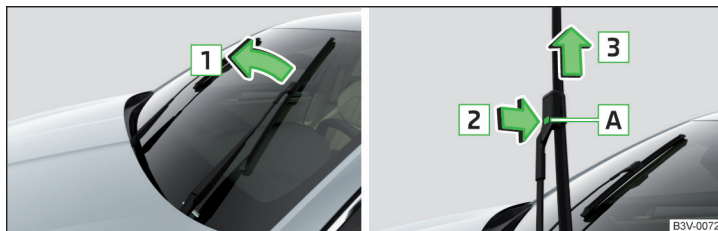
Fig. 354 Cambiar las escobilla limpiacristales del parabrisas
