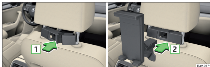
Fig. 115 Introducir: Adaptador / soporte
