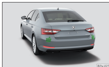
Fig. 271 Lugar de instalación de los sensores de radar
