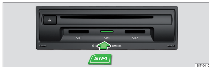
Fig. 202 Introducir la tarjeta SIM en el módulo externo
