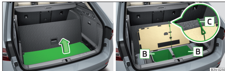
Fig. 134 Variante 2: Elevar la moqueta / Compartimentos guardaobjetos
