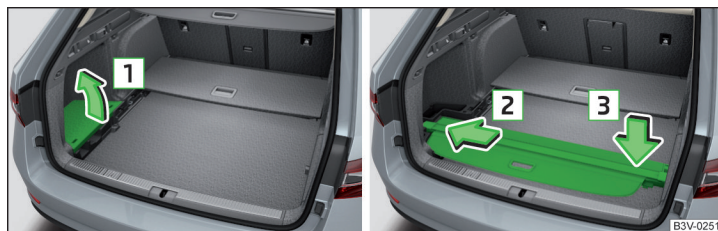
Fig. 129 Extraer la cubierta lateral izquierda / Guardar la cubierta enrollable
