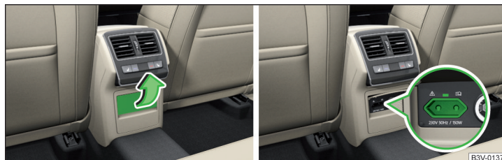
Fig. 112 Abrir la cubierta del enchufe de 230 voltios / Enchufe de 230 voltios
