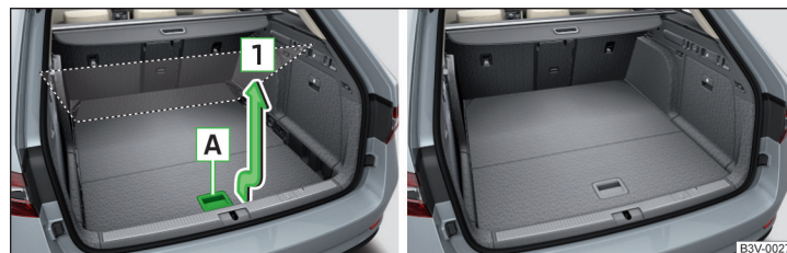
Fig. 139 Ajustar el suelo de carga variable en la posición superior / Suelo de carga variable en la posición superior
