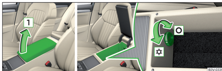
Fig. 95 Abrir compartimento guardaobjetos / manejar la entrada de aire
