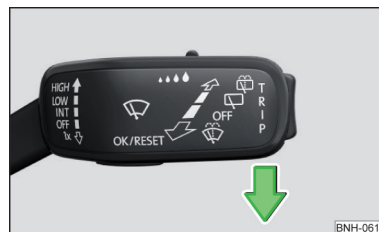
Fig. 353 Ajustar la posición de servicio de los brazos del parabrisa
