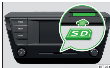
Fig. 188 Infotainment Swing: Introducir tarjeta SD
