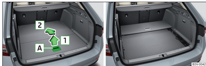
Fig. 141 Plegar el suelo de carga variable / El suelo de carga variable plegado en la posición superior
