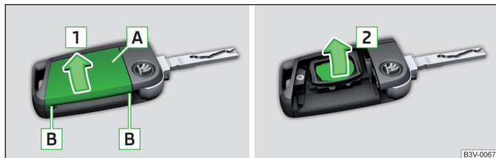
Fig. 343 Desmontar la tapa / extraer la pila
