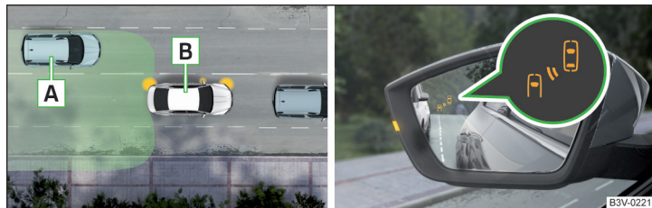
Fig. 273 Situación de conducción / Testigos de control en el retrovisor izquierdo avisa sobre la situación de conducción
