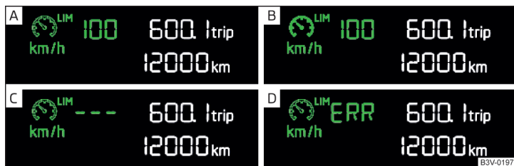
Fig. 291 Pantalla de segmentos: ejemplos de las visualizaciones del estado del dispositivo de limitación de velocidad
