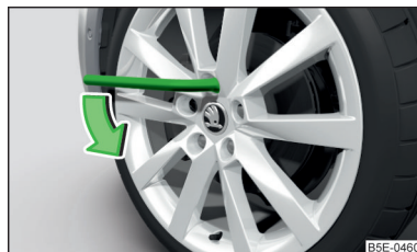
Fig. 335 Aflojar los tornillos de rueda
