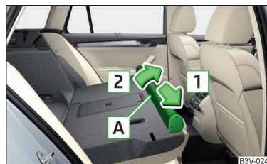
Fig. 145 Desmontar la carcasa de la red de separación
