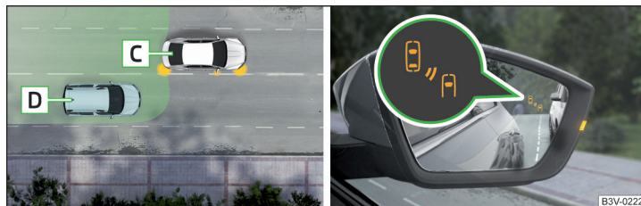
Fig. 274 Situación de conducción / Testigos de control en el retrovisor derecho avisa sobre la situación de conducción
