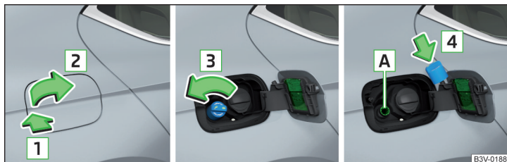
Fig. 321 Abir la tapa del depósito/ desenroscar el cierre del depósito/ colocar el cierre del depósito en la tapa del depósito
