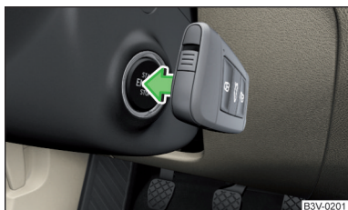
Fig. 256 Arrancar el motor - Colocar la llave en el botón
