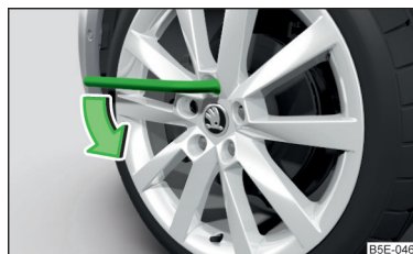
Fig. 339 Aflojar los tornillos de rueda
