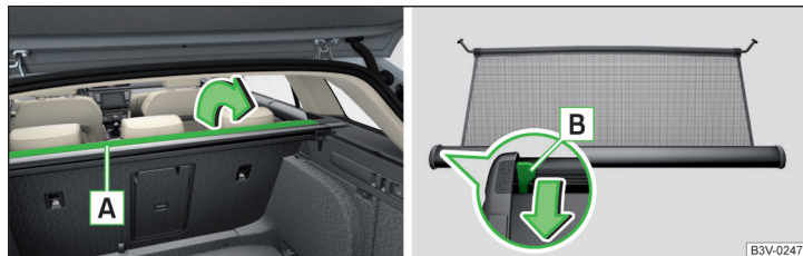
Fig. 162 Abrir la parte de la cubierta enrollable del maletero / Palanca para desbloqueo
