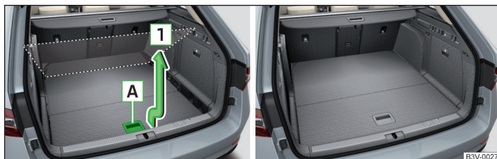
Fig. 158 Ajustar el suelo de carga variable en la posición superior / Suelo de carga variable en la posición superior
