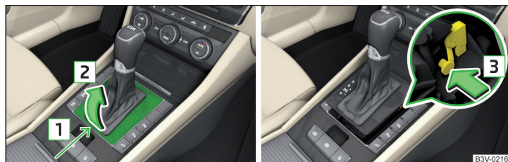
Fig. 356 Retirar la tapa / desbloquear la palanca selectora
