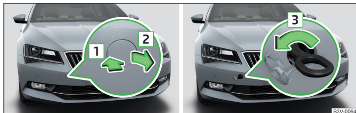
Fig. 345 Retirar la caperuza / instalar la argolla de remolque
