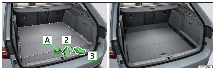
Fig. 159 Ajustar el suelo de carga variable en la posición inferior / Suelo de carga variable en la posición inferior
