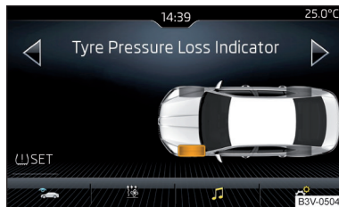
Fig. 312 Tecla para el almacenamiento / Ejemplo en la visualización de la pantalla: se indica a un cambio de presión de los neumáticos adelante a la izquierda
