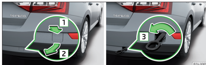
Fig. 346 Retirar la caperuza / instalar la argolla de remolque
