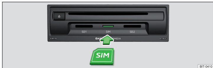
Fig. 211 Introducir la tarjeta SIM en el módulo externo
