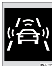
Fig. 304 Pantalla del cuadro de instrumentos combinado: Preaviso y/o frenado de emergencia con baja velocidad
