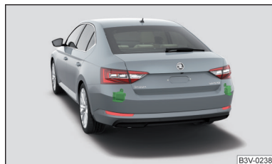
Fig. 275 Lugar de instalación de los sensores de radar
