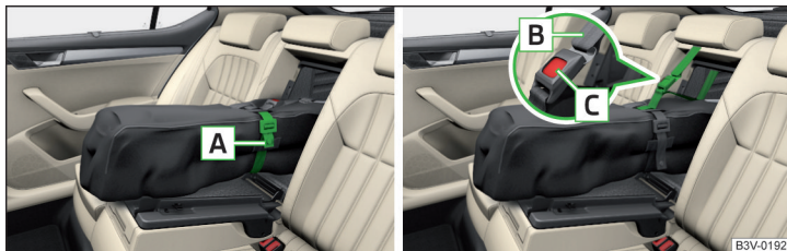
Fig. 126 Apretar banda / asegurar bolsa para carga de gran longitud
