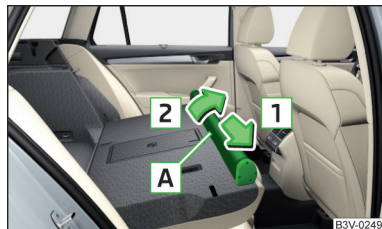
Fig. 164 Desmontar la carcasa de la red de separación
