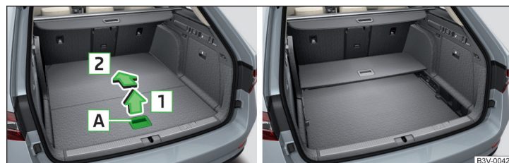
Fig. 160 Plegar el suelo de carga variable / El suelo de carga variable plegado en la posición superior
