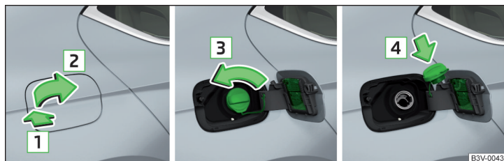
Fig. 319 Abrir la tapa del depósito/ desenroscar el cierre del depósito/ colocar el cierre del depósito en la tapa del depósito
