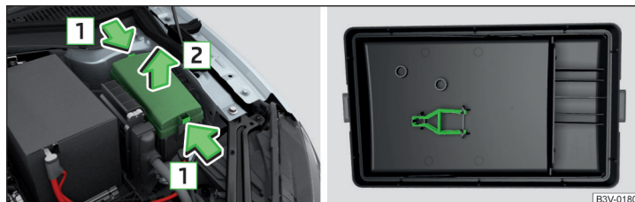
Fig. 365 Tapa de la caja de fusibles: Retirar la tapa / abrazadera plástica para fusibles
