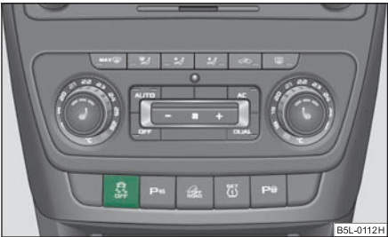
Fig. 191 Interruptor del ESP
