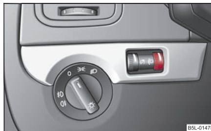
Fig. 58 Cuadro de interruptores: Regulación del alcance luminoso de los faros
