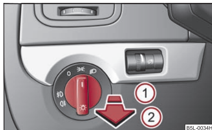
Fig. 56 Cuadro de interruptores: Conmutador luz
