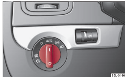
Fig. 8 Cuadro de interruptores: Conmutador luz
