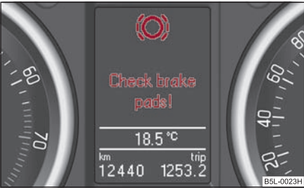
Fig. 33 Pantalla informativa: Forro de frenos desgastado
