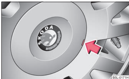
Fig. 223 Retirar el embellecedor de rueda en ruedas de aleación ligera
