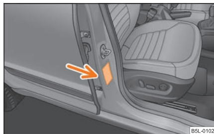
Fig. 181 Adhesivo en el montante central de la carrocería, lado del acompañante
