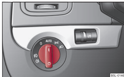
Fig. 55 Cuadro de interruptores: Conmutador luz
