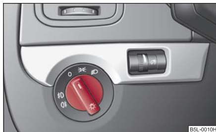
Fig. 54 Cuadro de interruptores: Conmutador luz
