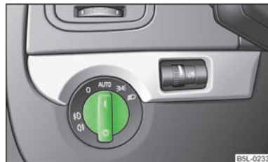
Fig. 24 Cuadro de interruptores: Conmutador luz
