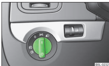
Fig. 23 Cuadro de interruptores: Conmutador luz
