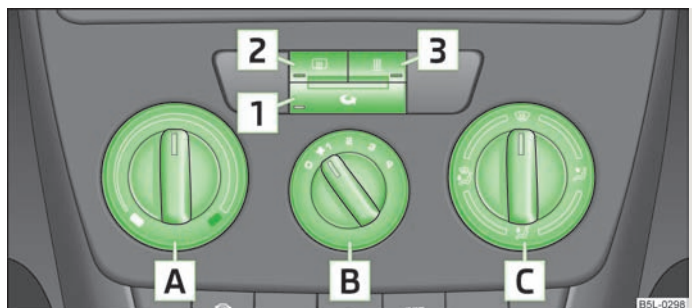
Fig. 88 Calefacción: Elementos de mando
