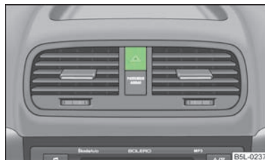
Fig. 28 Cuadro de interruptores: Inte- rruptor para el sistema de inter- mitentes simultáneos
