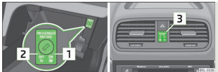
Fig. 129 Compartimento guarda objetos: Conmutador para airbag frontal del acompañante/testigo para desconexión de airbag del acompañante
