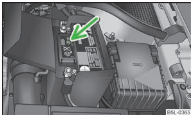
Fig. 149 Batería del vehículo: Indicador del nivel de ácido
