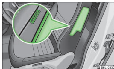
Fig. 125 Lugar de montaje de los airbags laterales en el asiento del conductor
