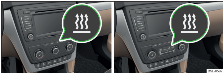
Fig. 119 Tecla de conexión/desconexión directa del aire acondicionado manual/Climatronic en la unidad de mando
