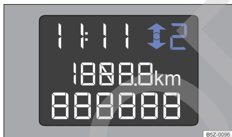
Fig. 96 En el panel de instrumentos : indicador de cambio de marcha (variante 2).
