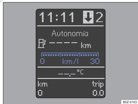
Fig. 42 En el panel de instrumentos: indicador del consumo de combustible.
