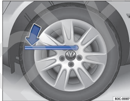
Fig. 185 Cambio de rueda: aflojar los tornillos de la rueda.
