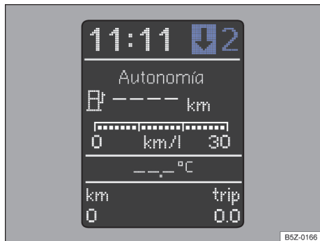
Fig. 95 En el panel de instrumentos : indicador de cambio de marcha (variante 1).
