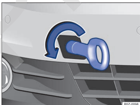
Fig. 162 En el parachoques delantero a la derecha: enrosque la argolla de remolque.
