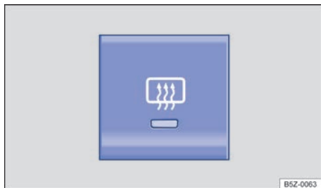
Fig. 92 En la consola central: botón del desempañador de la luneta.
