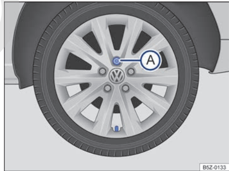
Fig. 187 Cambio de rueda: secuencia de desmontaje de los tornillos de la rueda.
