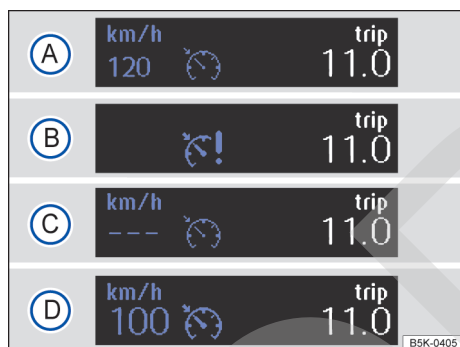
Fig. 108 En el display del panel de instrumentos: indicadores del estado del GRA.
