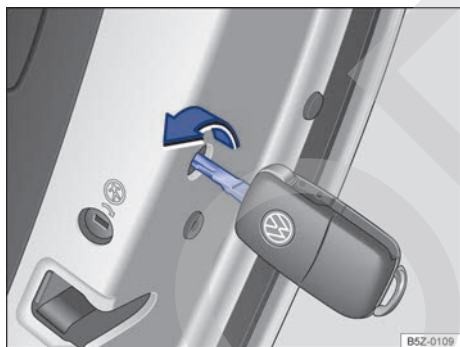
Fig. 59 Cierre de emergencia del vehículo con la llave del vehículo.
