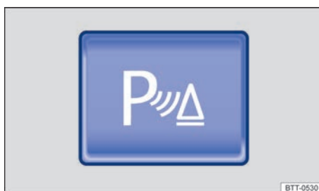
Fig. 111 En la parte superior de la consola central: pulsador para activar y desactivar el control de distancia de aparcamiento (Park Pilot). ▶
