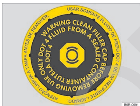
Fig. 174 En el compartimento del motor: tapón de cierre del depósito del líquido de frenos (variante 1).
