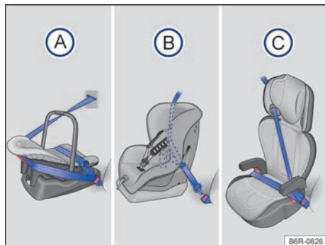
Fig. 17 Las ilustraciones (A), (B) y (C) muestran la fijación del sistema de retención infantil sólo con el cinturón de seguridad del vehículo.
