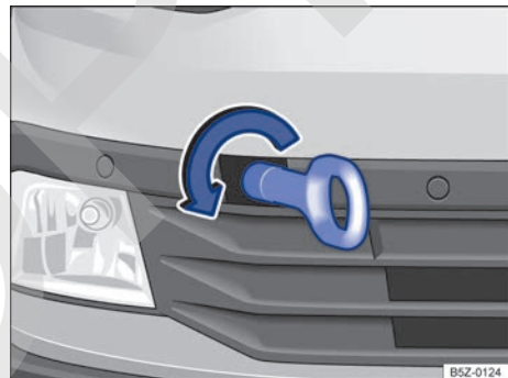
Fig. 164 En el parachoques delantero a la derecha: enrosque la argolla de remolque.
