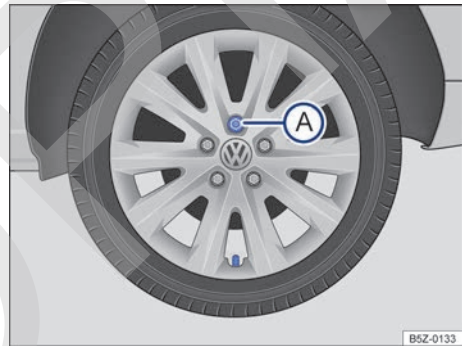
Fig. 184 Retire el tapacubos integral.
