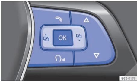
Fig. 44 Lado derecho del volante multifunción: teclas de mando de los menús del panel de instrumentos.
