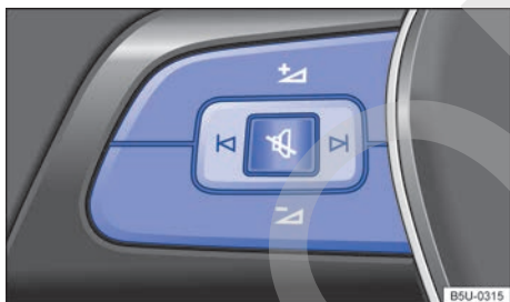
Fig. 45 Lado izquierdo del volante multifunción: teclas de comando.
