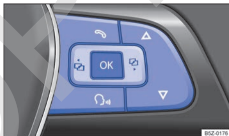
Fig. 46 Lado derecho del volante multifunción: teclas de comando.
