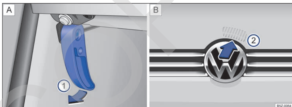
Fig. 167 A: palanca de desbloqueo en la zona reposapiés del lado del conductor ①. B: palanca de desbloqueo en la parte interior de la tapa del compartimento del motor ②.
