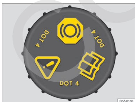
Fig. 175 En el compartimento del motor: tapón de cierre del depósito del líquido de frenos (variante 2).
