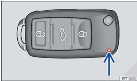
Fig. 49 Luz de control de la llave del vehículo con comando remoto.
