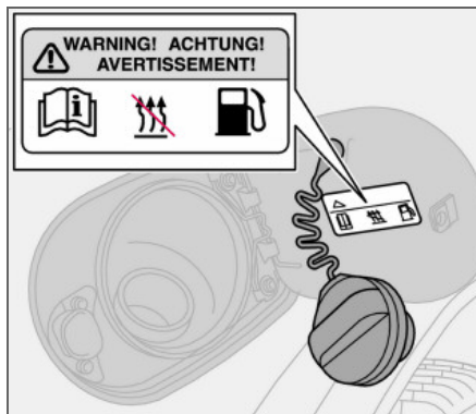
Placa de advertencia en la tapa del depósito.
