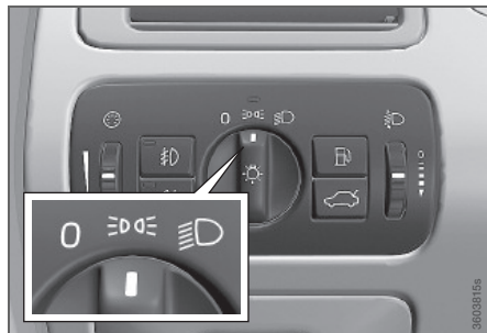
Mando en posición de luces de posición/luces de estacionamiento.
