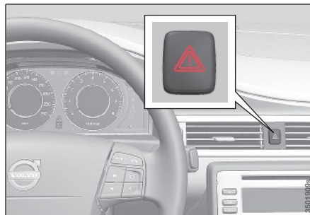
Luces de emergencia
