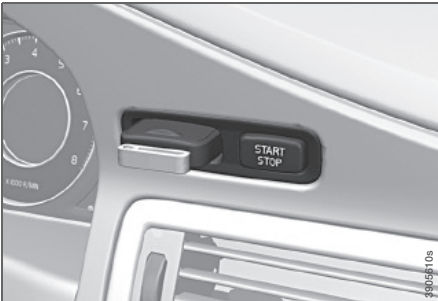
Cerradura de arranque con llave a distancia, interruptor de arranque/parada
